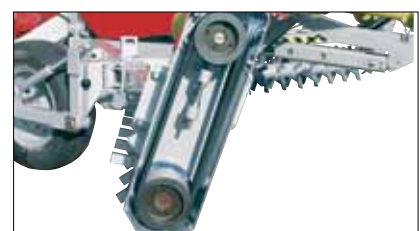
Transmisión de rastrillos hileradores.
