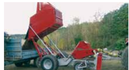
La altura de descarga es de 2.3m con gran estabilidad.
