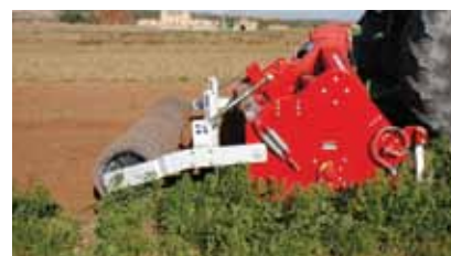
La criba trasera lleva muelles de presión.
