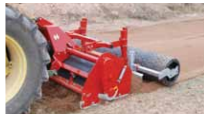
El capó de goma flexi-top absorbe los impactos y permite trabajar en suelo húmedo.
