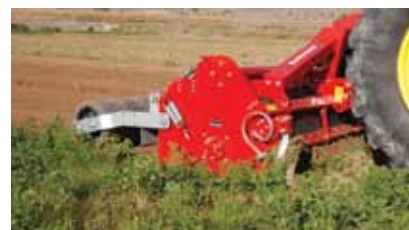
El capó es oscilante en la parte frontal.
