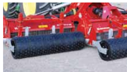
El rodillo de goma permite el trabajo en suelos húmedos permaneciendo limpio.
