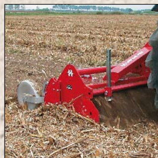
El Rotavator es el sistema más efectivo para el desterronado y la incorporación de residuos.
