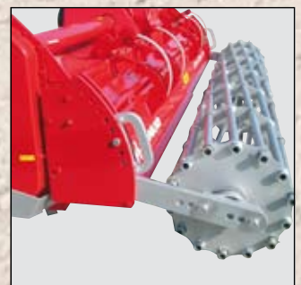
Sistema de control de profundidad compacto para Ruedas y rodillos traseros.
