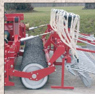
El montaje del tren de siembra sobre el rodillo del preparador asegura una profundidad de siembra muy precisa.
