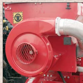
Turbina accionada por toma de fuerza, para transportar la semilla.
