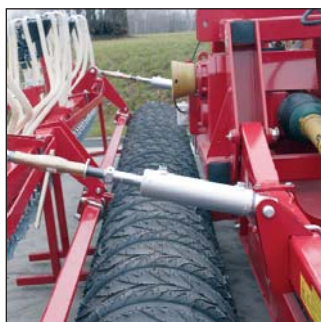
Control hidraulico de la seccion de siembra.
