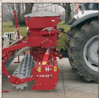
La tolva de gran capacidad está montada muy cerca del tractor y a una altura de carga muy reducida.
