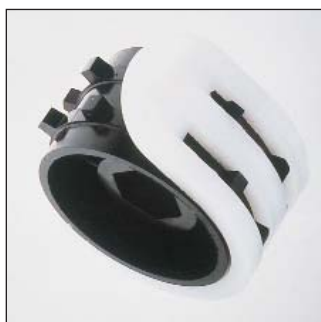
Montando lengüetas para semillas finas se reduce el paso de semilla a 1/3 de la capacidad normal. Valido para colza, alfalfa etc.
