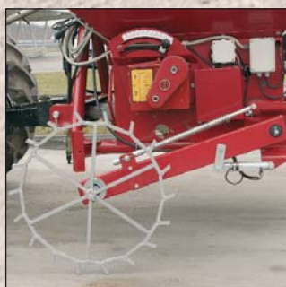
Las dosis se regulan en función de la rueda (versión mecánica) o por medio de un dispositivo electrónico.
