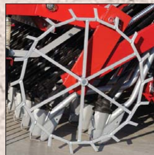
La rueda de gran diámetro asegura una transmisión fiable en todo tipo de condiciones.
