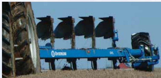
Mayor altura libre bajo al chasis para mejorar el despeje.
