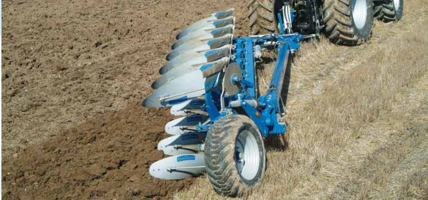
CVL 6975 H. Barra de tiro elevada para mejorar el despeje.
