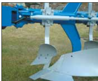
Raseta EG (normal) corte ancho. Trabaja bien en combinación con cuchilla o con disco.
