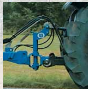
Detalles de las partes reforzadas de la barra de tiro.
