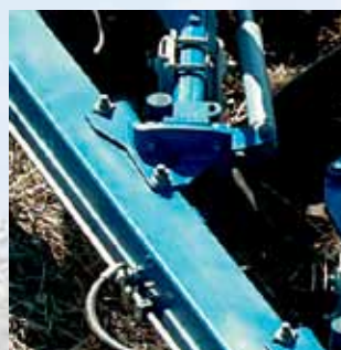
Ajuste del ancho de labor en 14", 16" o 18" (35, 40 o 45cm).
