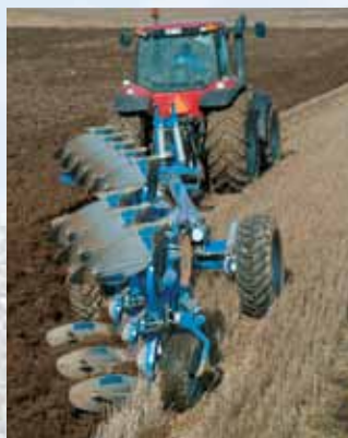
Överum DXL 81075 H. El ancho de labor puede ajustarse a 16", 18" o 20". Óptimo despeje para trabajar sin obstrucciones.
