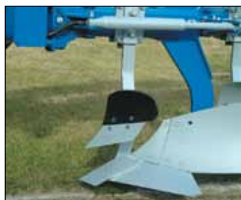
Raseta EP. Vertedera de plástico para suelos pegajosos.
