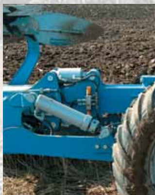
El carro Överum DXL tiene una unión controlada hidráulicamente, lo que permite flexibilidad cuando se está trabajando.
