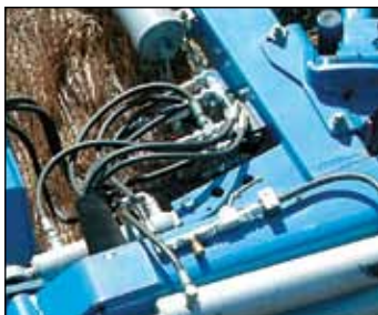
Válvula de control. Dos funciones se controlan mediante una salida doble.
