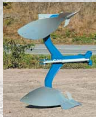
El perfil reforzado del ánora permite un óptimo despeje.
