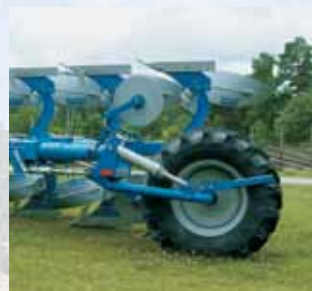
Rueda de gran dimensión con dirección hidráulica y un ajuste sencillo de la profundidad.
