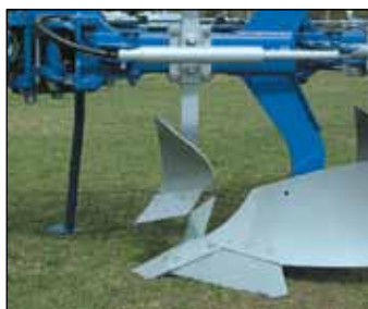
Raseta EM (maíz) para grandes cantidades de rastrojo. Mejor trabajo en combinación con la cuchilla.
