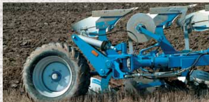
Rueda de grandes dimensiones, con poca resistencia y ajuste direccional.
