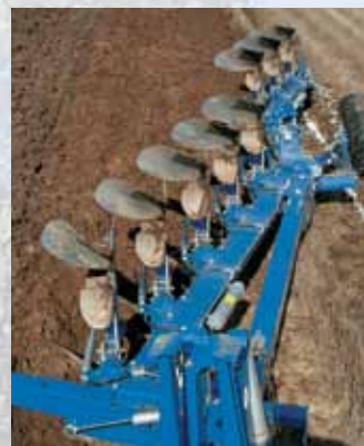
Överum DXL 81075 H. El ancho de labor puede ajustarse a 16", 18" o 20". Óptimo despeje para trabajar sin obstrucciones.
