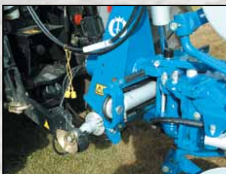
Ajuste hidráulico del ancho del primer surco para modelos CX/DX.
