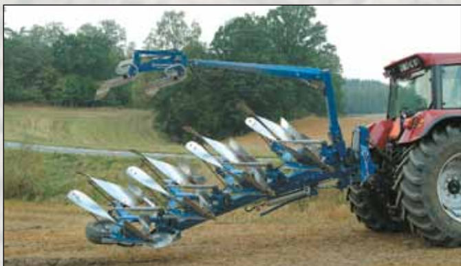
El volteo de las vertederas por encima requiere una potencia de elevación ligeramente superior. Cuando los cuerpos voltean por debajo del chasis es suficiente con una altura de elevación menor.
