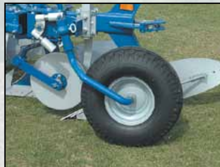
Rueda combinada 10.00x12. Diámetro 710mm y ancho 264mm.
