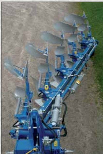
La estudiada geometría del sistema de regulación hace posible ajustar el ancho de labor en marcha con una presión relativamente baja.
