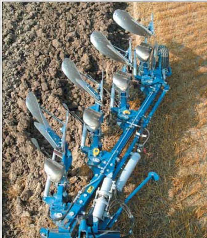
El uso de taladradoras de precisión permite un gran ensamblaje, basado en tornillos, en un chasis principal tratado térmicamente.
