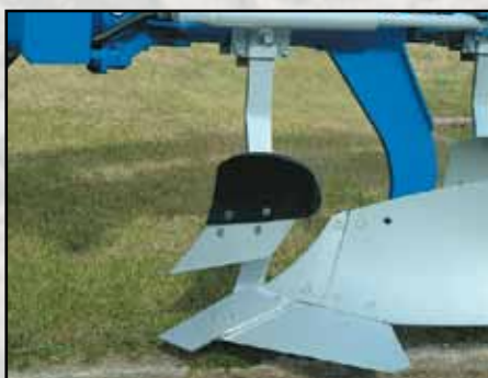
Raseta EP. Vertedera de plástico para suelos pegajosos.
