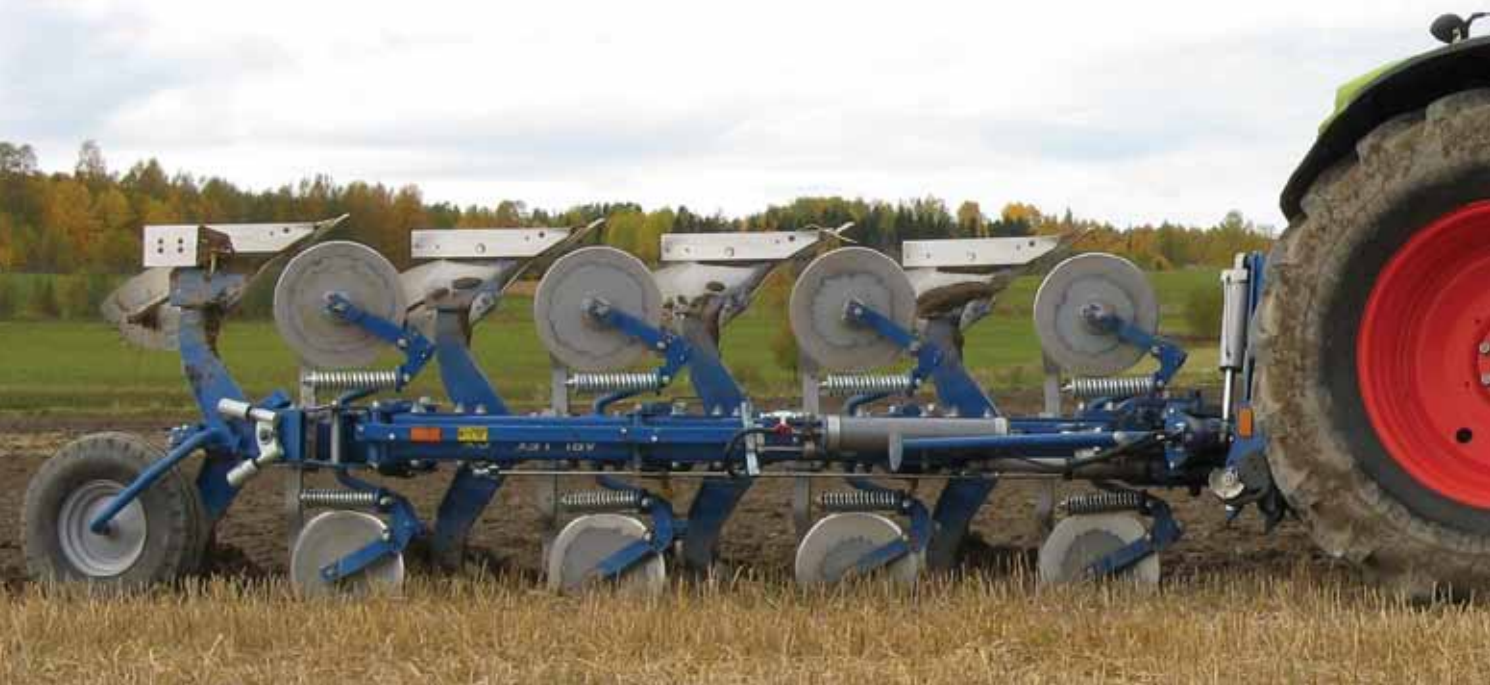
Vari Flex CX 4975 H con ajuste hidráulico del ancho de labor desde 12" a 20".
