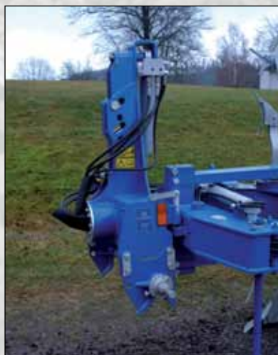
Robusto cabezal Cat.3 con eje de volteo 150/180mm y rodamientos de agua, para una distribución eficiente de grandes cargas. Barra de enganche rápido, con posibilidad de ajustar tanto la altura como la longitud. Bloqueo de transporte en mariposa estándar.
