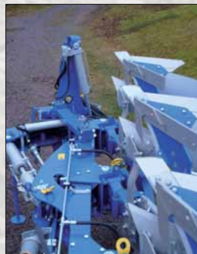
Brida de sujeción y cilindro doble con largos brazos dan menos esfuerzos y una larga vida útil. El ancho de surco se ajusta fácilmente incluso en condiciones difíciles.
