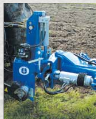
Cabezal reforzado con enganche rápido y cilindro de alineamiento.
