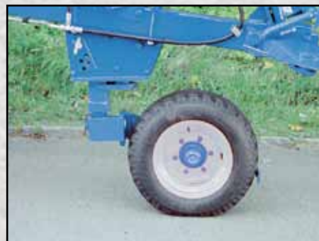
Rueda combinada en posición avanzada para el modelo Xcelsior DX. Diámetro 755mm y ancho 275mm.
