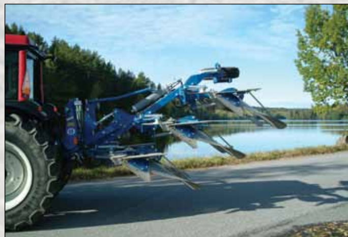
Como las vertederas voltean por debajo del chasis, el centro de gravedad está más cerca del tractor, facilitando la elevación del arado.
