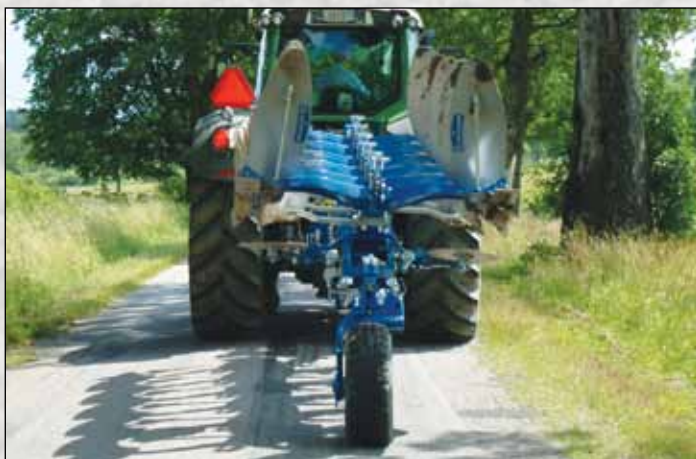
Posición de mariposa para aliviar al tractor durante el transporte.
