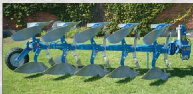
Xcelsior DX 5975 F con rueda de control combinada y una nueva sujeción para la raseta.
