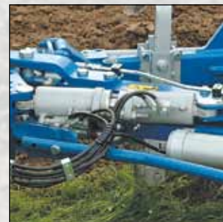
El doble cilindro memoriza el ancho de surco durante el alineamiento y volteo del arado.
