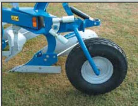
Rueda de control neumática 7.00x12. Diámetro 645mm y ancho 182mm.
