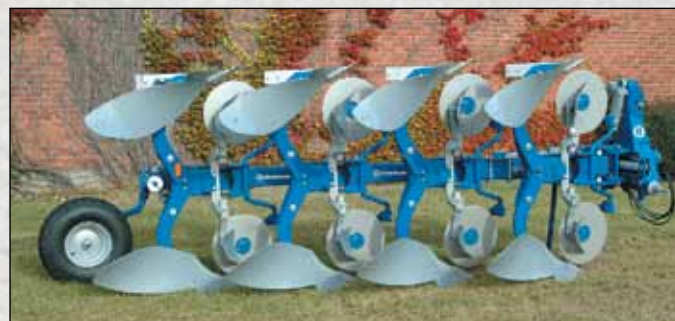
Vari Flex CX 4975 F con discos fijos y rasetas normales (EG). Los cuerpos y las rasetas están protegidos por tornillo fusible.
