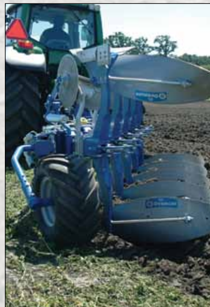
Nueva rueda de control de profundidad, con un amplio rango de ajuste y un neumático ancho para un buen seguimiento del contorno del terreno. Al voltear, se amortiguan los golpes ajustando el freno de fricción.
