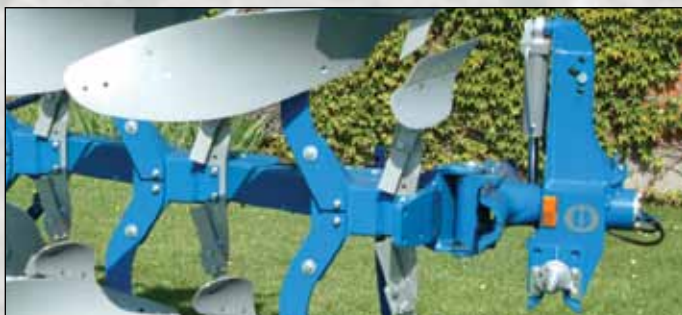
Xcelsior CX equipado con un nuevo cabezal, el cual permite un fácil enganche.
