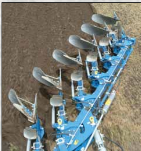
El tiro puede ajustarse exactamente, lo que permite ahorrar combustible y reduce el desgaste. Robusto bastidor 220x120mm sin soldadura. Rueda combinada de 260/70-16, opcional 340/55-16.
