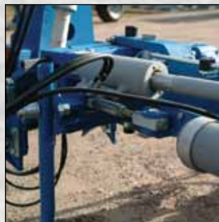
Con el tensor se puede alinear perfectamente el arado, reduciendo el tiro lateral.
