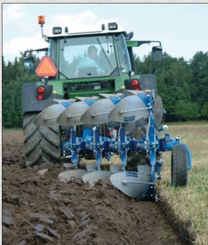
CX 4975 H equipado con cuerpos XL y rasetas normales EG para dejar un surco limpio.
