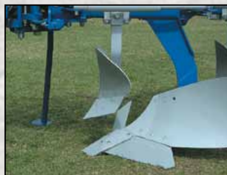
Raseta EM (maíz) para grandes cantidades de rastrojo. Mejor trabajo en combinación con la cuchilla.
