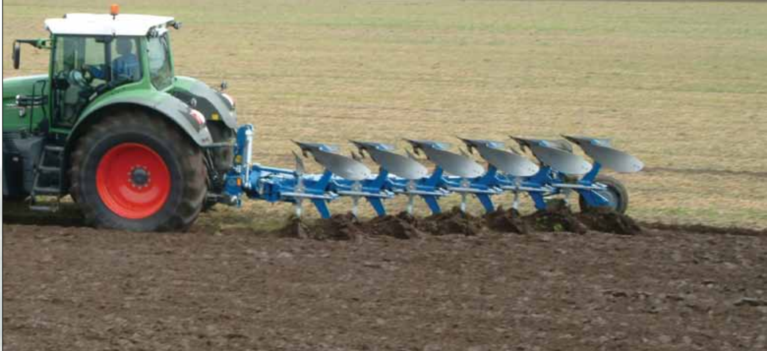
Vari Flex EX 6975 H con ajuste hidráulico del ancho de trabajo hasta 3,3m.
