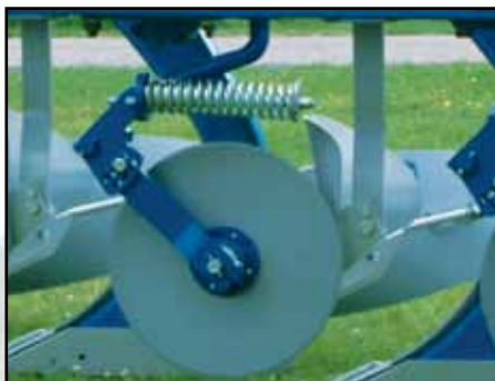
Disco con muelle de protección. De 18" o 20" liso o 20" ondulado.
