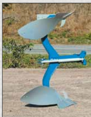
Las áncoras de gran despeje permiten trabajar en campos con grandes cantidades de rastrojo.
