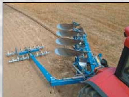
Rastra de nivelación "Nivell" para arados de 3 a 4 surcos.
