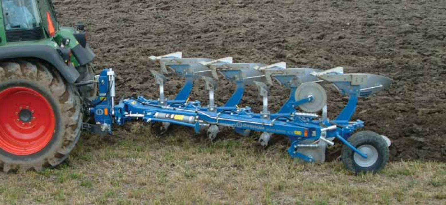
CX 4975 H con rasetas normales (EG). Distancia entre cuerpos de 90cm, permite el montaje de todos los tipos de rasetas.
