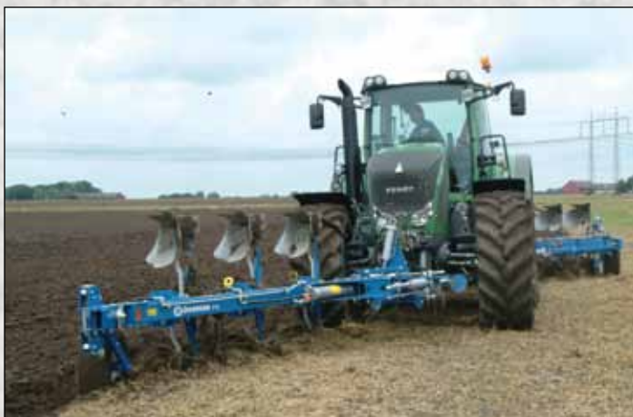
Con la combinación de Vari Flex EX 6975 H y el arado frontal FX 31075 H se consigue un ancho de labor de 4,5m. Una preparación del terreno a un bajo coste.
