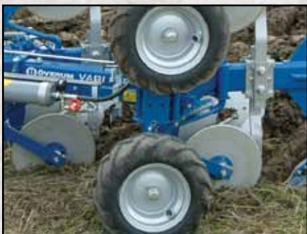
Doble rueda para modelos BX, CX y Vari Flex CX. Diámetro 575mm y ancho 210mm.
