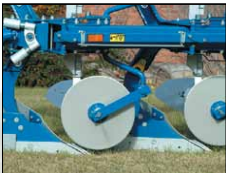
Disco fijo. De 18" o 20" liso o 20" ondulado.
