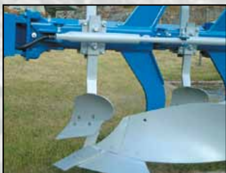
Raseta EG (normal) corte ancho. Trabaja bien en combinación con cuchilla o con disco.
