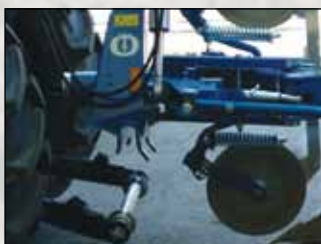
Barra de enganche rápido para una conexión fácil y segura.
