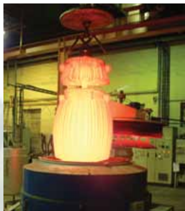
Cementación de las vertederas.
