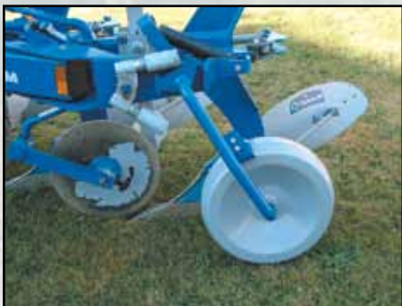
Rueda de control metálica. Diámetro 500mm y ancho 160mm.
