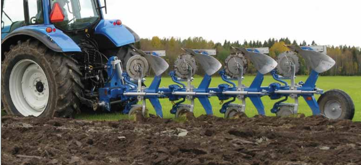
Xcel­sior CX 4975 H con discos de corte y rasetas normales (EG). Ajuste del ancho de labor entre 140-180cm.
