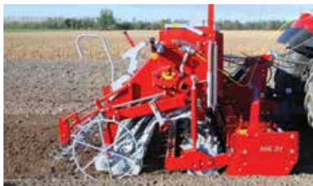
El peso de la sembradora recae sobre el rodillo del cultivador.
