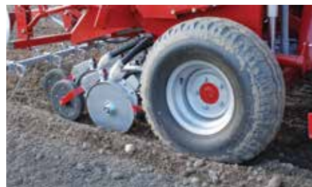
Preciso y fiable sistema de dosificación accionado por gran rueda de tracción.
