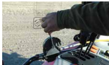
Ajuste de la dosis sobre la marcha, desde la cabina del tractor.
