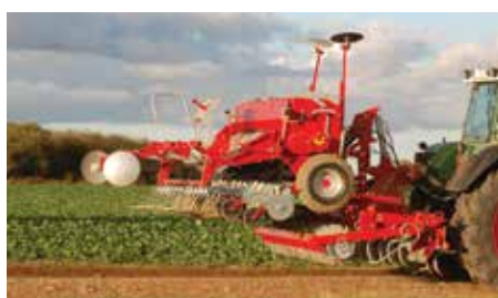
Enchance hidráulico para montar la sembradora sobre del cultivador.
