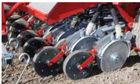
Doble disco de siembra (DR) con ruedas de compresión de goma.
