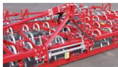
Enganche rápido para facilitar el acople.
