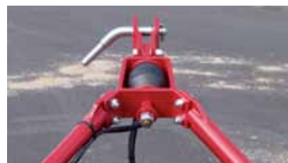
Estabilizador de goma para proteger la máquina y el tractor.
