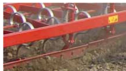
Placa niveladora con o sin púas para desterronar o nivelar el terreno, antes de que los brazos entren a trabajar.
