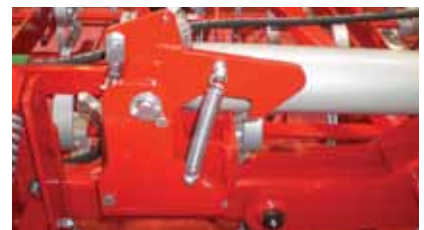
Sistema hidráulico o mecánico de bloqueo de las secciones laterales, accionado desde la cabina del tractor.
