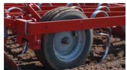
Cuatro ruedas de control de profundidad de perfil ancho, permiten ajustar la profundidad de forma exacta.
