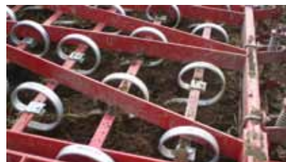
5 hileras de brazos situados en un patrón asimétrico, asegura un flujo, sin bloqueos, de terreno y residuos.
