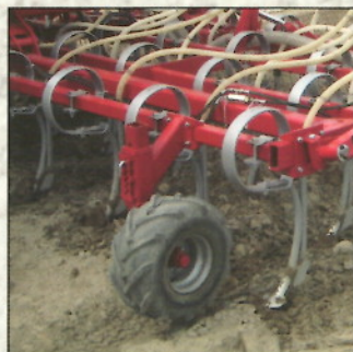
El control de profundidad se consigue a través de los neumáticos de amplia y baja flotación de la sembradora.
