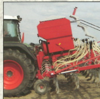
El diseño compacto asegura un punto de gravedad próximo al tractor.
