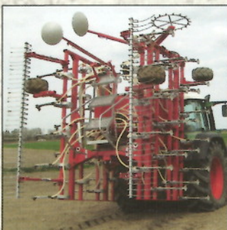
La estructura plegable en 2 secciones asegura un ancho de transporte de 3 m.
