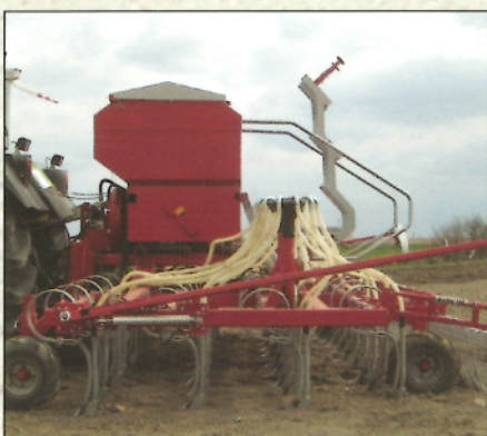
4 hileras de brazos que dan un despeje muy elevado para evitar problemas con los restos de cultivo depositados en el suelo.
