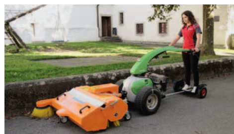
Rapid Mondo con spazzatrice combinata, contenitore raccogli-sporco e spazzola laterale
