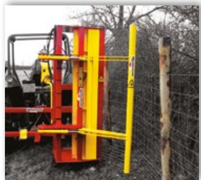
Unwinding and tightening the wire netting Spannen Desenrollado y tensado de ta tela metálica
