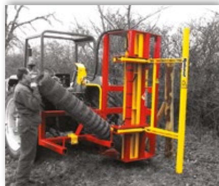
Loading the wire netting Einladen Carga de la tela metálica
