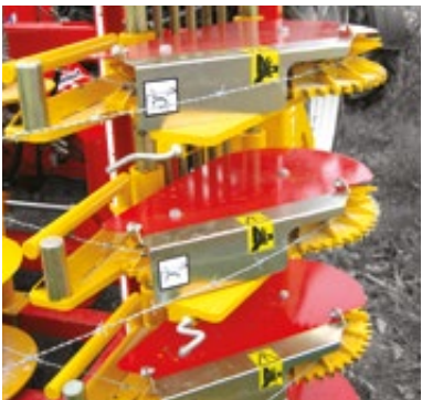
Regular tightening thanks to sprocket wheels and their independent brakes Gleichmäßige Spannung der Drähte dank der individuell gebremsten Abrollständer Apriete regular gracias a la rueda dentada ruedas y los frenos independientes
