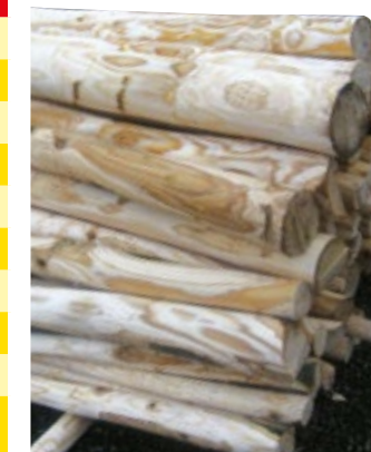
Posts after debarking Entrindete Pfähle Postes después del descortezado
