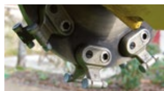
Teeth with carbide Karbidzähne Los dientes con carburo
