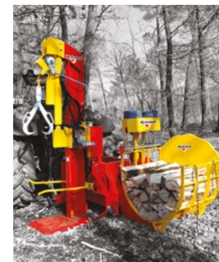
Coupling at 90° (FARMER II + BUNDLING MACHINE) 90° Anbau (Modell FARMER II + Bündelgerät) El acoplamiento a 90° (FARMER II + Agrupación mac Hine)
