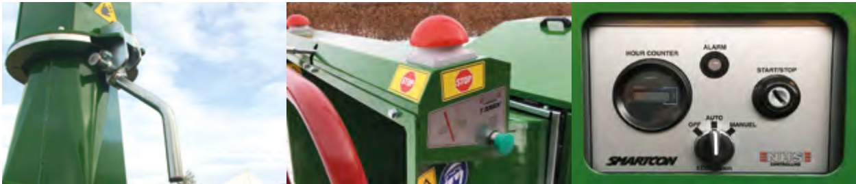
El tubo de descarga giratorio de 360 ° es estándar en todas las máquinas. Función de parada de emergencia totalmente integrada: funciona desde cualquier posición NHS SmartCon es extremadamente fácil de usar: inicio automático / apagado, activación del volante, antiestrés, contador de horas, EcoMotion (programa de ahorro de energía) y mucho más: 100% fácil de usar
