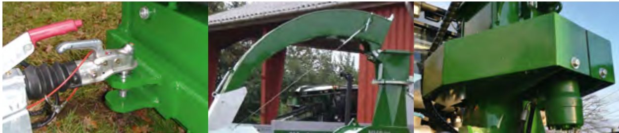
Todas las máquinas de la serie V están equipadas con barba de remolque para volquetes ligeros o similares.
