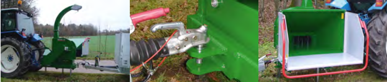
Flexible cuando quieras trae los chips a casa. La serie V está equipada con barra de remolque para volquete ligero o similar (presión máxima de la bola: 500 kg / remolque máximo: 2000 kg). La alimentación lateral es óptima para limpiar a lo largo del borde y la cuneta de la carretera.
