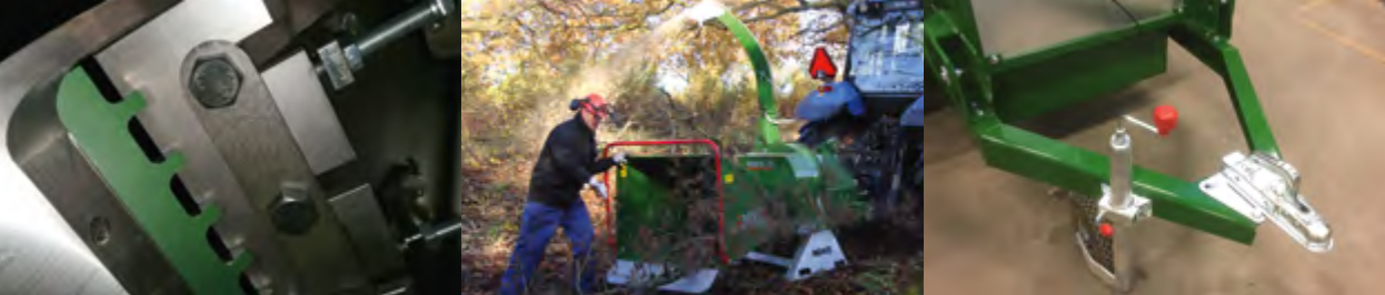
NHS Micro kit - simple pero eficiente para un chip extremadamente uniforme. El eficiente sistema de alimentación garantiza una gran capacidad y un entorno de trabajo óptimo. Amplia gama de opciones: aquí un juego de ruedas con enganche de bola de Ø50 mm.
