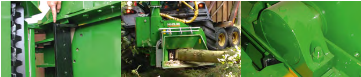
La carcasa embellecedora con bisagras proporciona un acceso óptimo a las cuchillas y contracuchillas para el mantenimiento.
