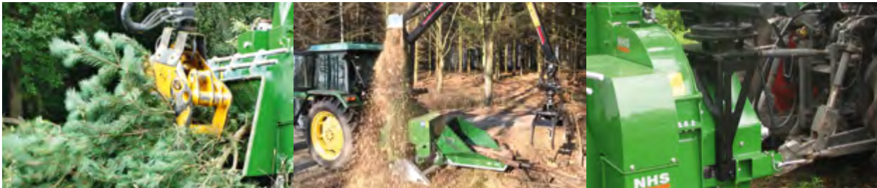
El peso modesto y el diseño compacto hacen que la máquina se pueda utilizar en tractores más pequeños.
