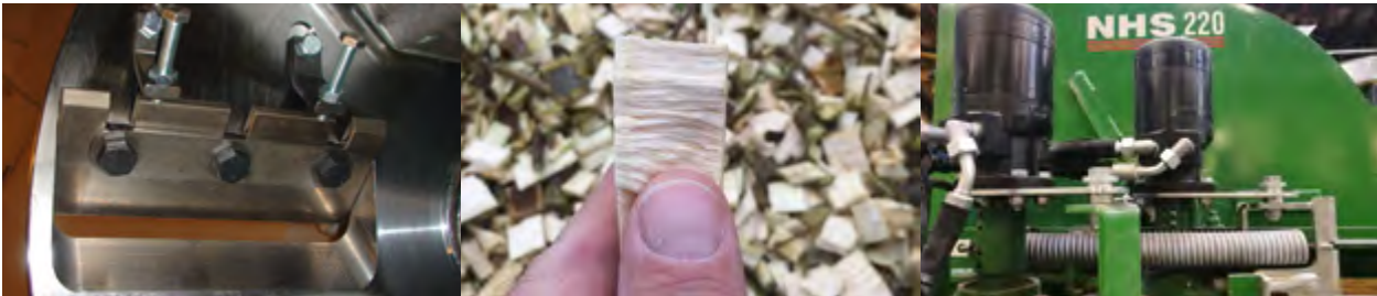
Cuchillas infinitamente ajustables aseguran, entre otras cosas, chips uniformes.
