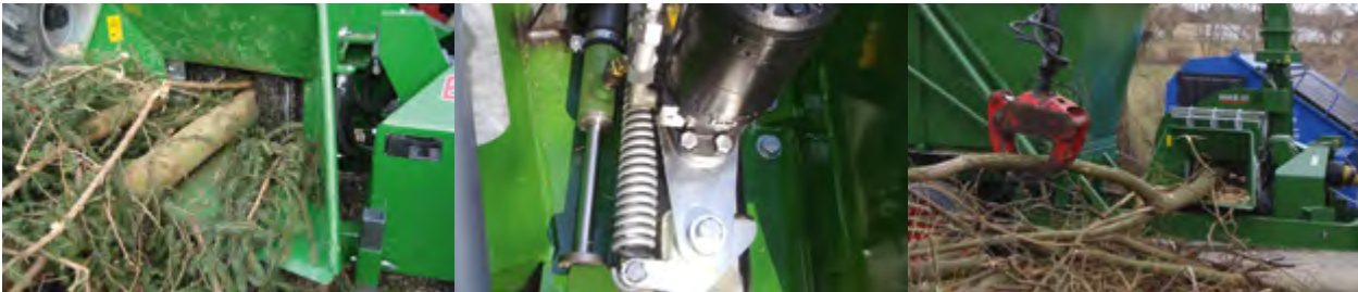
Los rodillos verticales y agresivos aseguran una alimentación buena y fiable.
