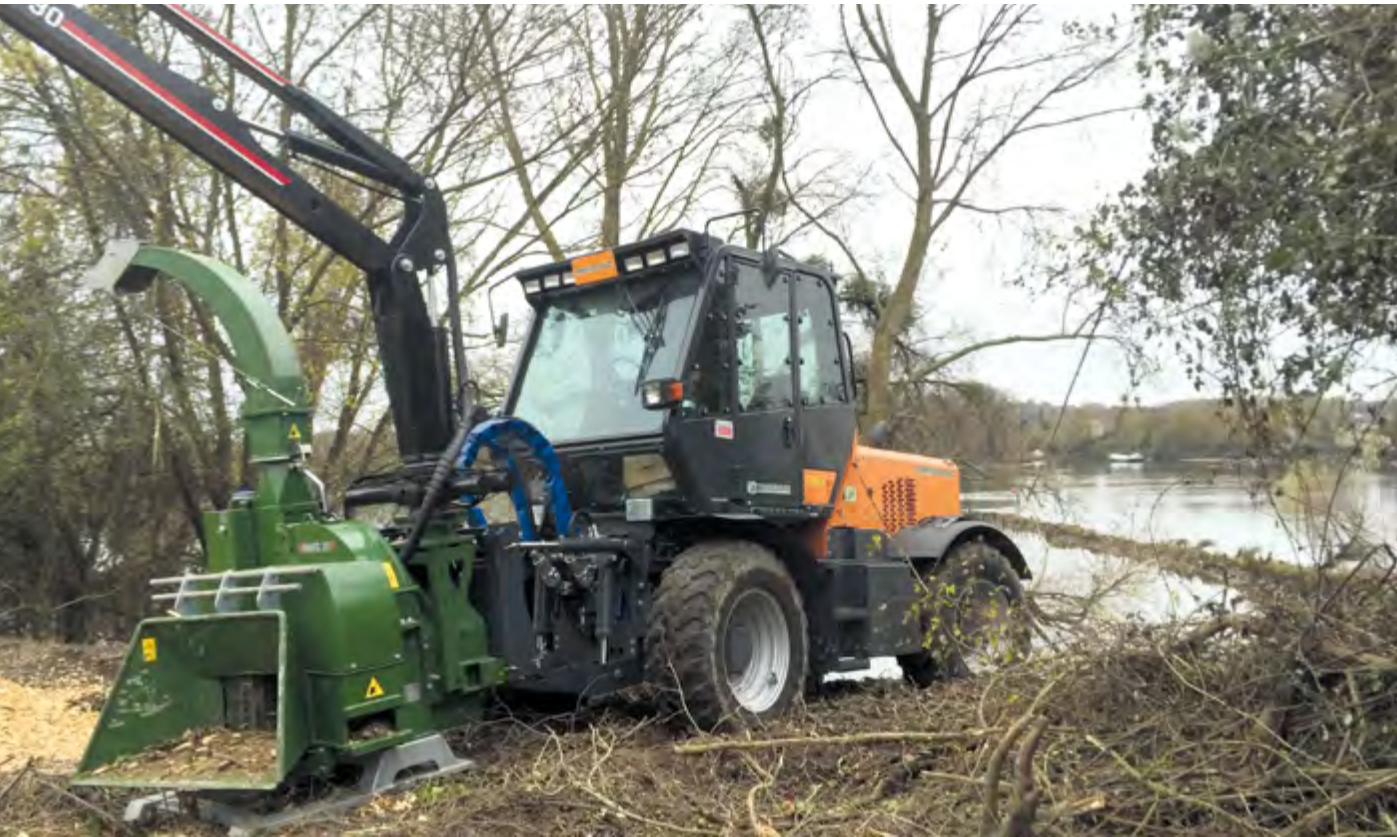
NHS300c - la máquina alimentada por grúa compacta y simple
