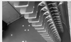
**Parrilla independiente** permite el ajuste granulométrico del material procesado; mayor distancia entre la parrilla y la compuerta trasera permite mejor flujo del material
