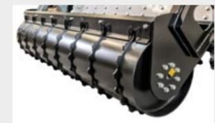
**Odillo de accionamiento hidráulico** con raspador para permitir auto limpieza del rodillo
