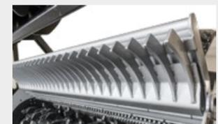
**Parrilla atornillada en compuerta** trasera permite el ajuste granulométrico del material procesado
