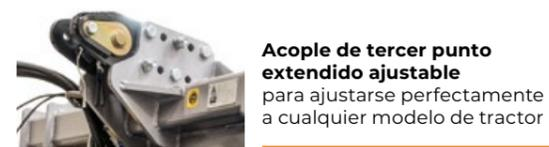
**Acople de tercer punto extendido ajustable** para ajustarse perfectamente a cualquier modelo de tractor
