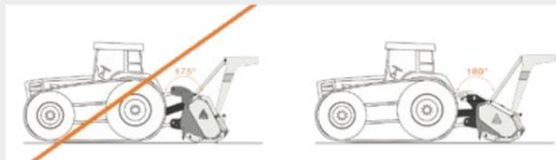
**Modelo diseñado para tractores con el eje de toma de fuerza PTO de bajo posicionamiento**
