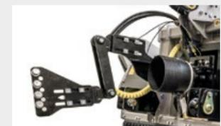
**Dispositivo de auto alineamiento entre eje de toma de fuerza PTO/transmisión tipo W** permite que el implemento trabaje en diversos ángulos sin dañar el PTO
