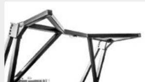
Estructura de empuje mecánica encanala el material antes de la trituración
