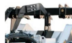
**Sistema autoajustable del eje de toma de fuerza PTO/transmisión tipo Z** manteniendo siempre el ángulo correcto de operación entre el eje PTO y el toma de fuerza
