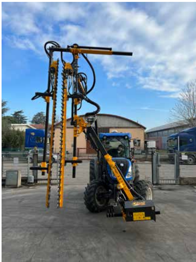
Chiusura max. Tunnel L. 300 cm - Max. closure Tunnel L. 300 cm Fermature Tunnel L. 300 cm - Max. Verschluss Tunnel L. 300 cm
