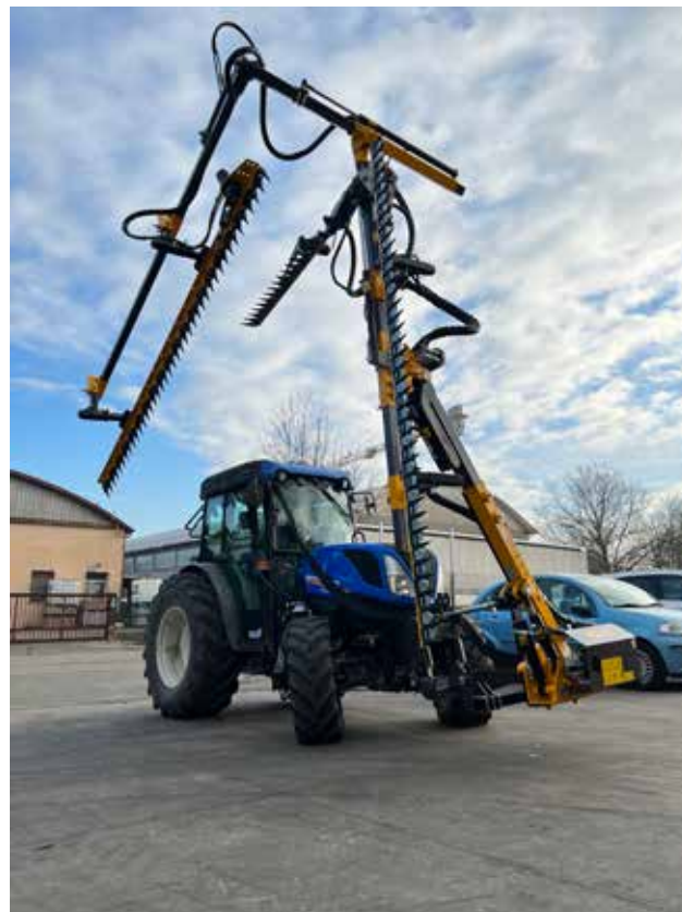
Rotazione 90° barra esterna - Rotation 90° of external bar Rotation 90° lamier extérieur - Rotation 90° der Außenleiste
