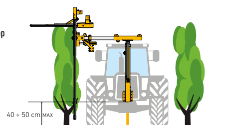
Molla sicurezza top Top spring security Ressort de sécurité top Top Sicherheitsfeder
