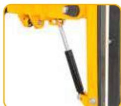
Molla gas antiurto - Gas spring security Securité avec vérin a gaz - Sicherheitsgasfeder
