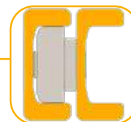
Montante duplex con cuscinetti Duplex profile with bearing Profil duplex avec roulement Duplexprofil mit Lager
