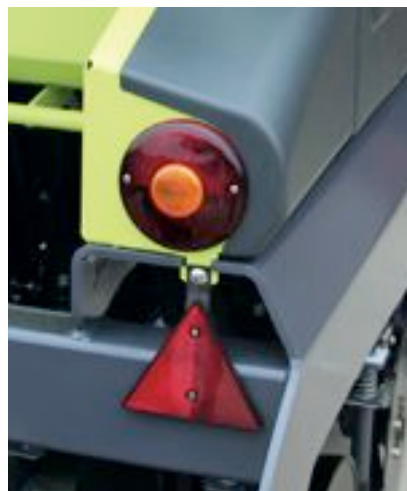
Luces integradas (mecánico)
