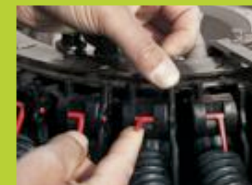
Cabeza de distribución ADS con gestión "a la carta" del número de hileras sembradas
