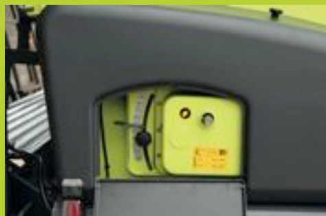
Variador de baño de aceite con rotación continua.
