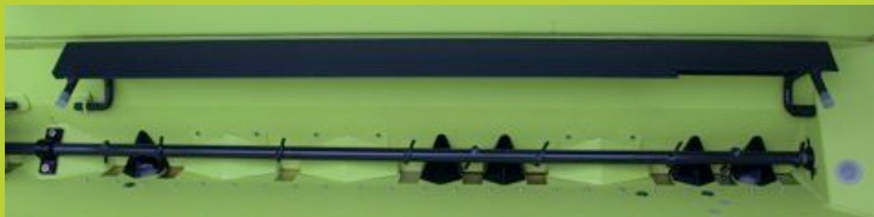
Fondo de la tolva con crestas de repartición para limitar el volumen muerto, agitador de rotación lenta y cúpula anti-asentamiento retráctil para mantener un flujo constante independientemente de la carga de la tolva.
