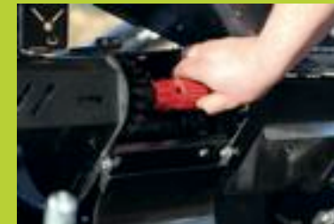
Desplazamiento de un piñón Para pasar a semilla pequeña
