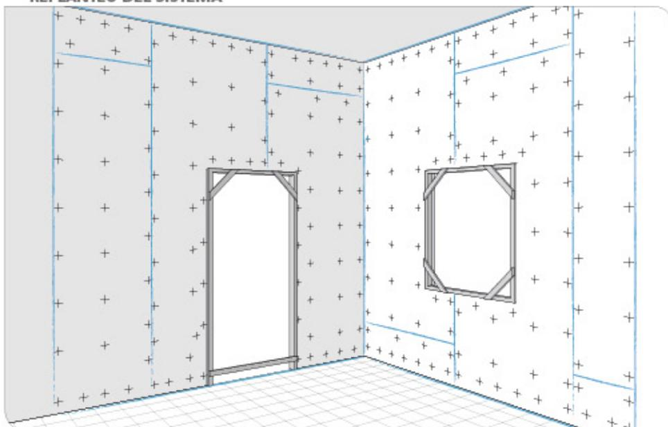
Se procede al trazado del trasdosado del muro con la ayuda de herramientas adecuadas. Se debe marcar la parte exterior del plano que se quiere conseguir, es decir, la suma de la placa y el grueso de pellada, teniendo especial cuidado de que la pellada, una vez colocada la placa, tenga un espesor entre 10 mm mínimo y 20 mm máximo. Es recomendable marcar las cuadrículas en el muro para posicionar las pelladas, así como los límites de cada placa.
