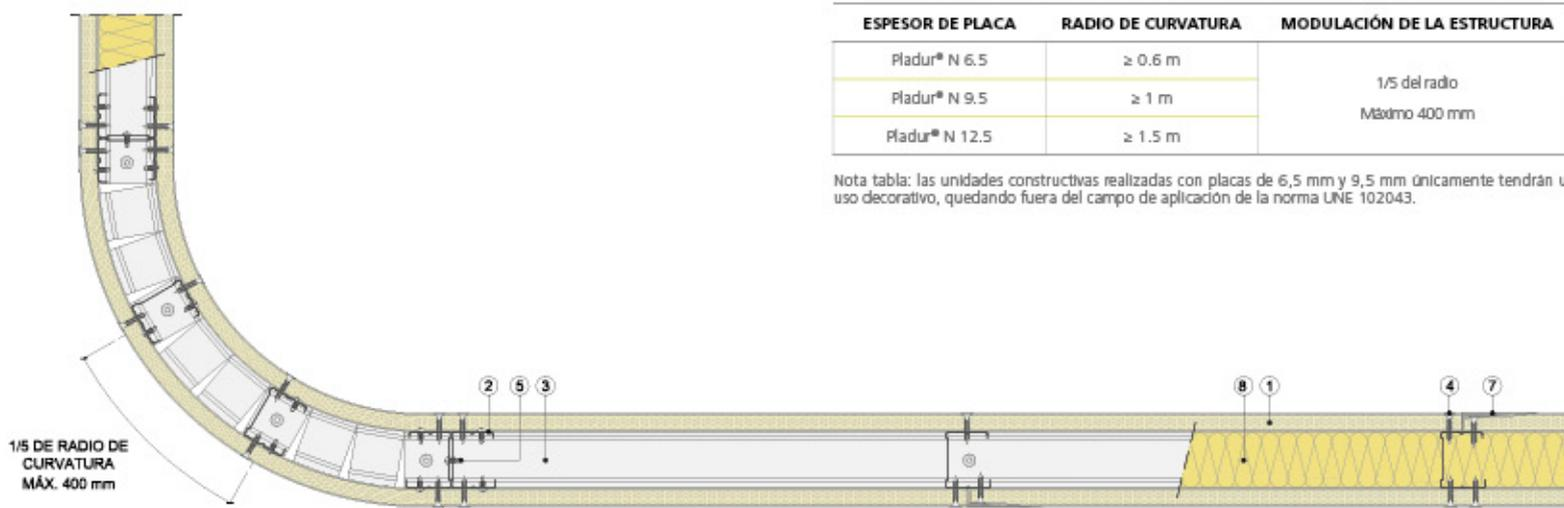
CURVADO DE PLACA SOBRE LA ESTRUCTURA PULVERIZANDO CON AGUA LA PLACA
