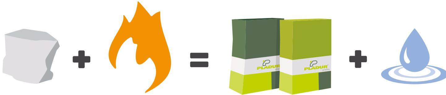
Aljez ( $\text{CaSO}_4 \cdot 2\text{H}_2\text{O}$ ) = Yeso ( $\text{CaSO}_4 \cdot 1/2 \text{H}_2\text{O}$ ) + agua ( $3/2 \text{H}_2\text{O}$ )
