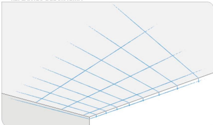
Se traza el perímetro del techo correspondiente a la parte baja de la estructura. Después se traza el posicionamiento de la estructura en el forjado. Se continúa marcando el lugar exacto de los cuelgues, respetando las medidas de arranque y distancia de cuelgues dependiendo de la composición de dicho techo. Se trazan los puntos críticos de las instalaciones si fuese necesario.
