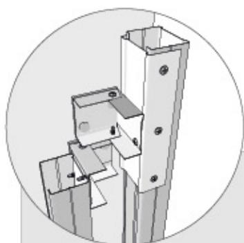
**Arriostramiento de montantes jamba y modulación (2 tornillos MM).**
