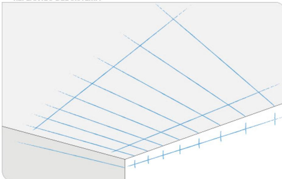
Se traza el perímetro del techo correspondiente a la parte baja de la estructura. Se marca la posición exacta de los montantes en ambos paramentos.
