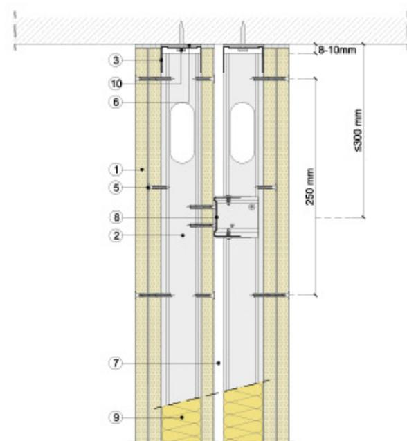
Canal de ala alta para permitir deformaciones del forjado
