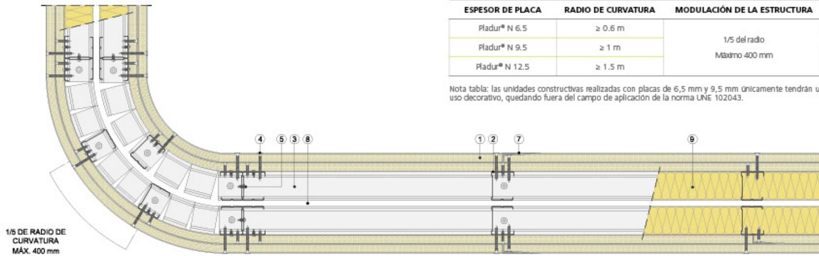
CURVADO DE PLACA SOBRE LA ESTRUCTURA PULVERIZANDO CON AGUA LA PLACA
