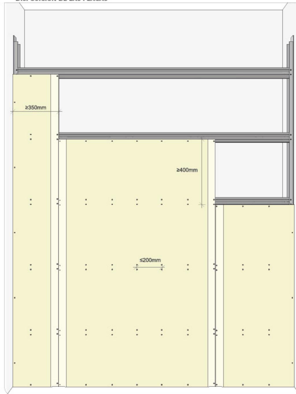
Terminado el proceso de trazado, se colocan los montantes encajándolos en ambos canales, procurando que los extremos se queden separados entre 8 mm y 10 mm de los muros. Dichos montantes se atornillarán a los canales en ambas alas con tornillos del tipo MM.
