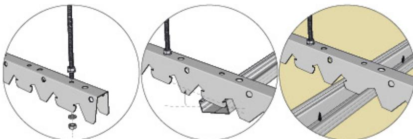
Con la estructura terminada, se coloca el aislante cubriéndola en su totalidad y haciendo que gire en los laterales del plénum hasta encontrarse con el forjado superior. Se colocan las placas en sentido transversal a la estructura secundaria, procurando que el trozo de placa más pequeño sea  $\geq 350$  mm. Las juntas de testas se contrapean al menos 400 mm.
