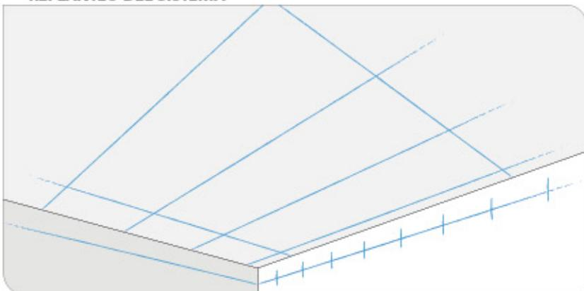
Se traza el perímetro del techo, correspondiente a la parte baja de la estructura secundaria. A continuación se traza el nivel de la estructura primaria y su posicionamiento en el forjado. Se sigue marcando el lugar exacto de los cuelgues, respetando las medidas de arranque y distancia de cuelgues dependiendo de su composición. Se trazan los puntos críticos de las instalaciones si se requiere.
