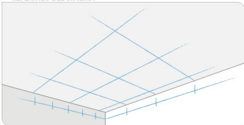
Se traza el perímetro del techo correspondiente a la parte baja de las estructuras primaria y secundaria. A continuación se marca la posición de todos los perfiles. También se marca la ubicación exacta de los cuelgues. Se tienen en cuenta todas las instalaciones que afecten al montaje del techo. En este apartado se decide cómo va a quedar el techo, por lo que es importante ajustarse a las recomendaciones de montaje.
