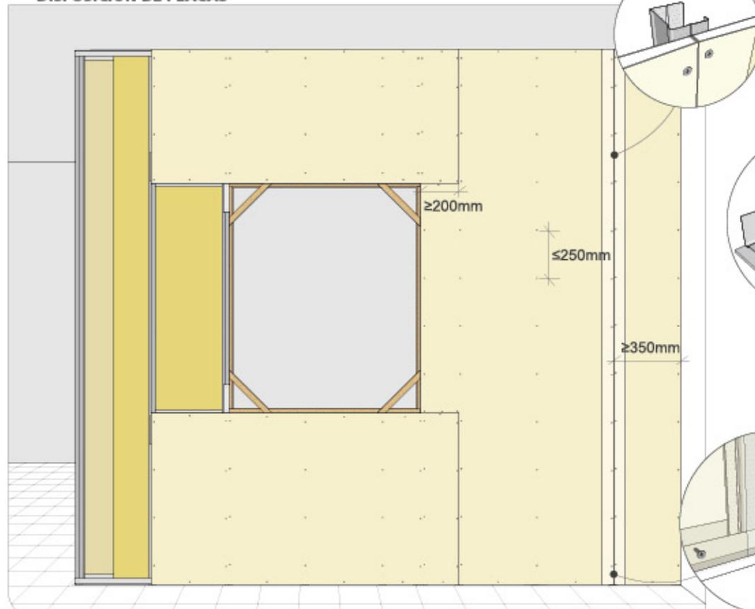
Con la estructura terminada, se coloca una de las caras de placa, las instalaciones y el material aislante. Durante la colocación de las placas se tiene en cuenta que no quede una pieza de placa inferior a 350 mm y se contrapean las juntas de una cara del tabique con respecto a la otra. Se contrapean también las testas de placa al menos 400 mm. La distancia de atornillado es de 250 mm entre tornillos. Colocadas todas las placas se procede a realizar el tratamiento de juntas definitivo.
