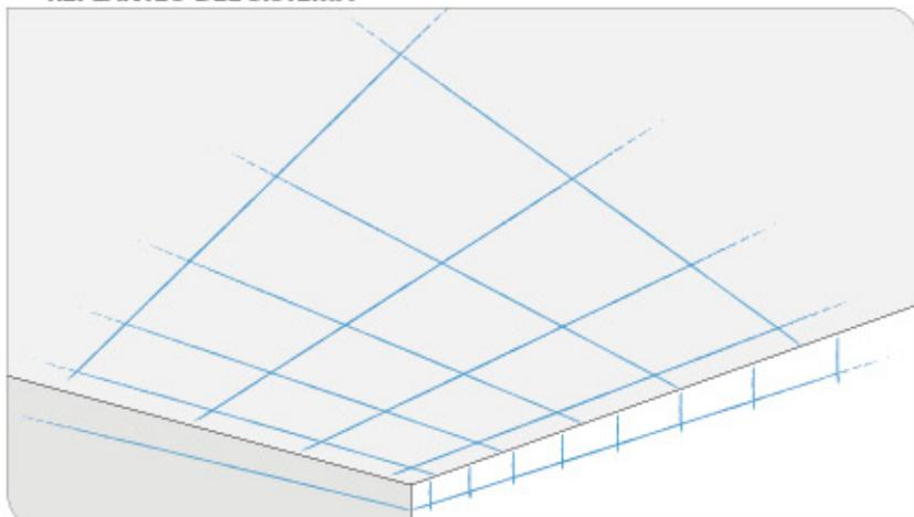
Se traza el perímetro del techo, correspondiente a la parte baja de la estructura secundaria. A continuación se marca la posición de la estructura primaria de perfiles PH-45, también se marca la ubicación exacta de los cuelgues. Se tienen en cuenta todos los casos que existan de instalaciones y que afecten al montaje del techo. En este apartado se decide cómo va a quedar el techo, por lo que es importante ajustarse a las recomendaciones de montaje.
