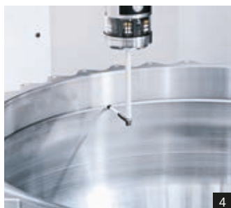
2: Torneado con eje A accionado* 3: Aplicación de herramientas de múltiples filos cortantes (máximo 9) 4: Ciclos de medición para la medición de piezas interna* 5: Equilibrado electrónico 6: Medición de herramientas para fresar y torneear*
