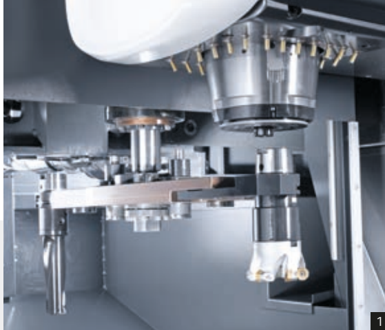
1: Doble pinza 2: Almacén de cadena vertical con 120 posiciones que no requiere ningún espacio adicional
