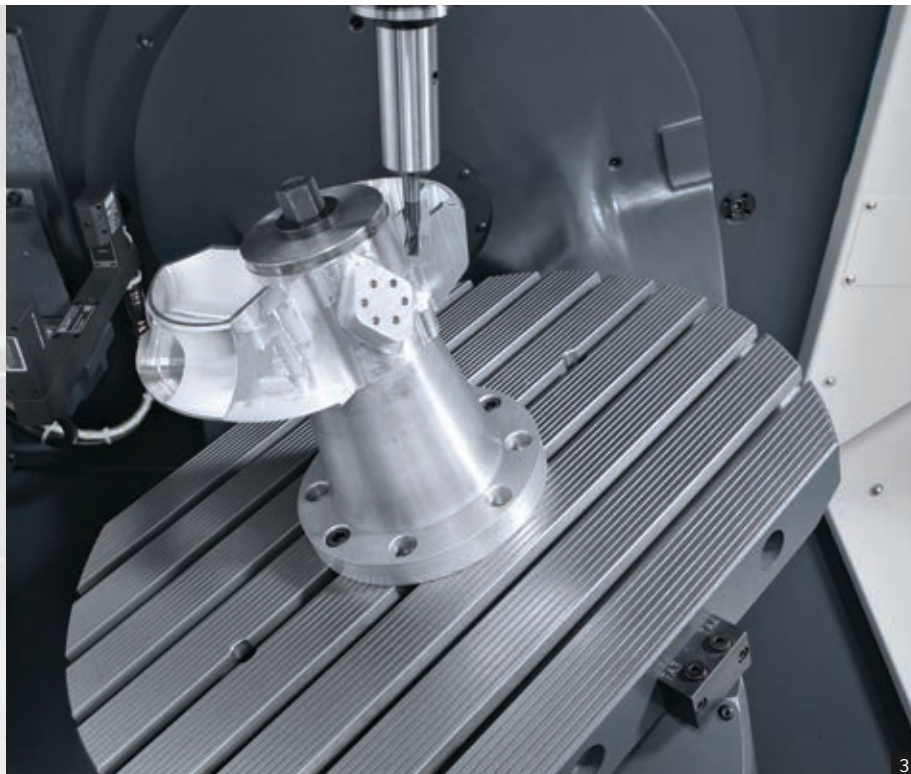
1: Mecanizado flexible con tres hasta cinco ejes 2: Área de mecanizado fácilmente visible, con almacén de herramientas opcional 3: Mesa para el mecanizado simultáneo
