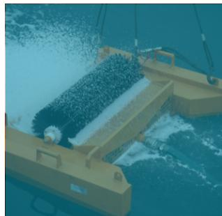
El Skimmer de cepillos utiliza un cepillo circular de cerdas oleófilas e hidrófugas como elemento principal de recuperación, cuya principal propiedad es la capacidad de rechazar el agua y adherir los hidrocarburos. Este principio asegura un alto rendimiento de recuperación de hidrocarburos de cualquier naturaleza con un mínimo contenido de agua (menos de un 5%).
