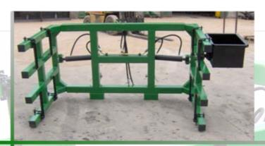
Permite prensar hidráulicamente pacas pequeñas para transformarlas en paquetes de mayor tamaño.
