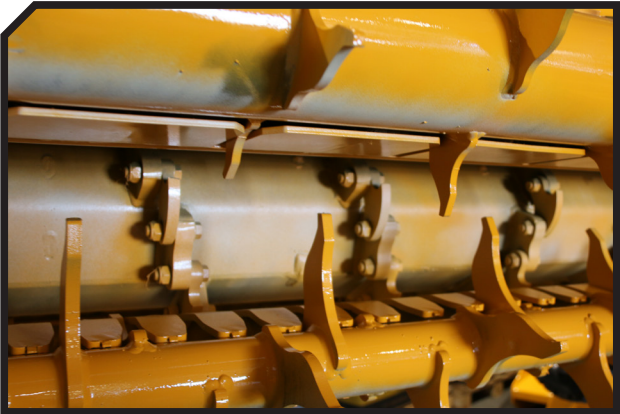
2 líneas de contramartillos por el exterior
