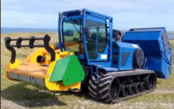
Trituradora BIOSYLVA, en una sola pasada, y a la velocidad habitual, es capaz de cortar y lanzar la hierba y matorrales de hasta 10 cm a un contenedor para evacuarlos del terreno.
