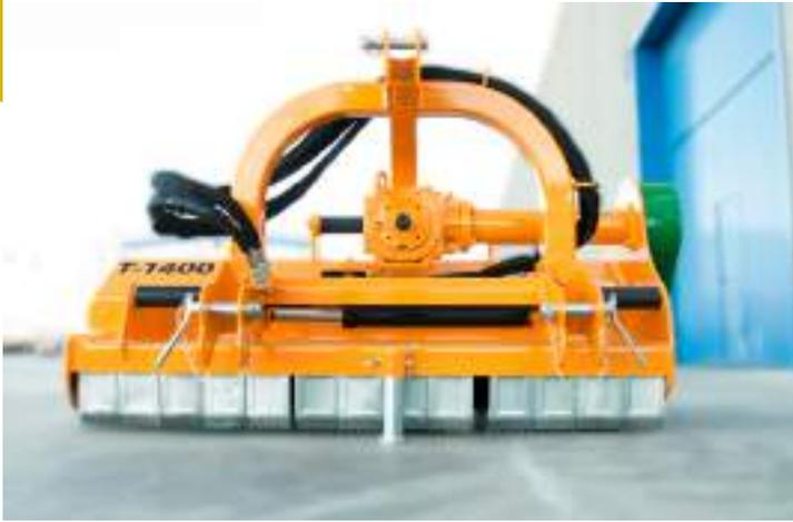
Trituradora diseñada para tractores desde 30 CV a 80 CV de potencia para la agricultura de mantenimiento del manto vegetal y ramas de hasta 5 cm de diámetro.
