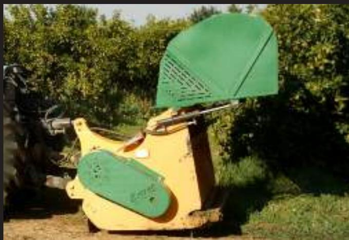
Trituradora apta para el corte y recogida de hierba y ramas hasta 8 cm de diámetro.
