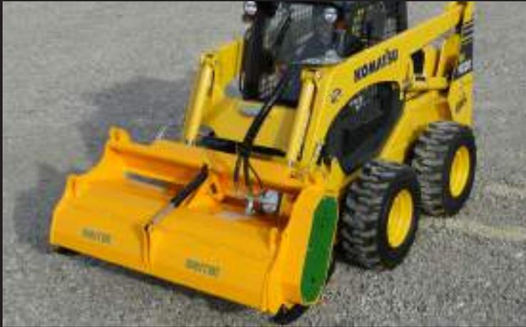
Cabezal adaptable para instalar a los brazos de elevación de minicargadoras hasta 5 TM., accionado con circuito hidráulico auxiliar existente.
