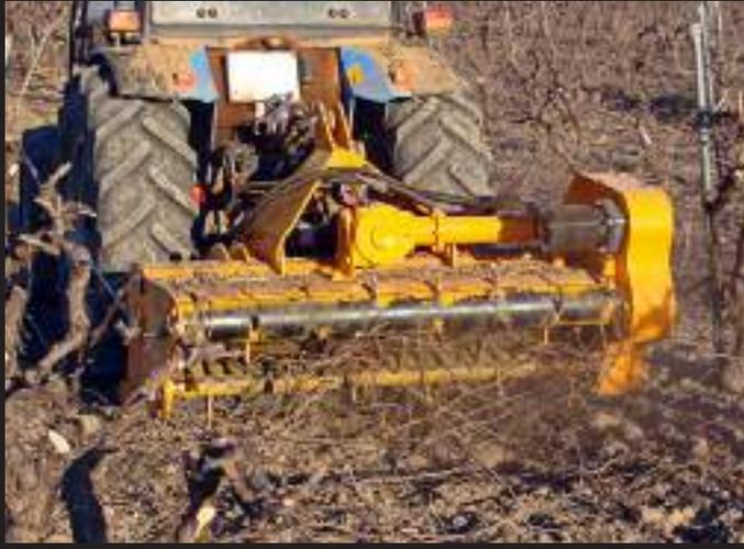
Trituradora con alimentador hidráulico reversible para tractores entre 60 - 90 CV, ideal para viña, uva de mesa, olivos, almendros, cítricos, etc. Máquina para trabajos exigentes, con necesidad de depositar restos muy finos en el terreno, evitando posible plagas y ayudando a su eliminación, para procesos posteriores. Equipa rotor de cuchillas RHENDUEL.
