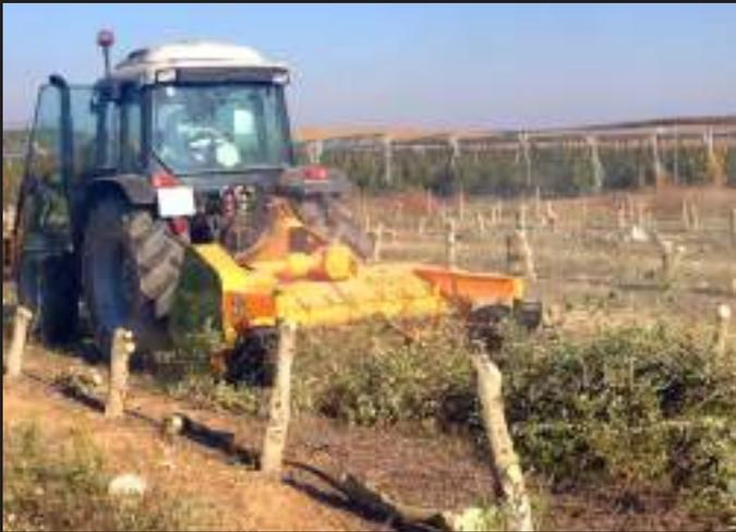
Trituradora con doble alimentador hidráulico ideal para restos de olivo, cítricos y frutos secos de hasta 5-7 cm de diámetro, con el rotor ÓCLAME de SERRAT para tractores de entre 70 y 110 C.V.
