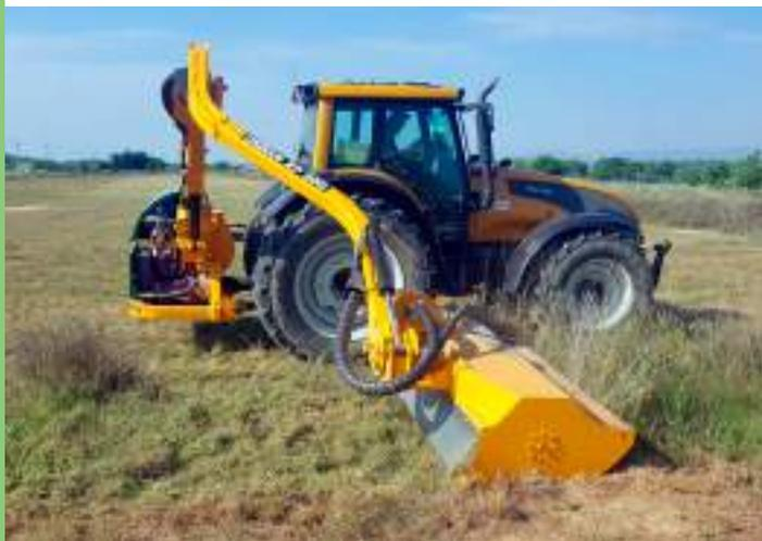
Gama profesional, URBANXP600 desbrozadora de carreteras, para la limpieza de maleza en cunetas, arcenes de carreteras y autopistas. Máquina para trabajos exigentes, con los últimos elementos hidráulicos, distribuidor proporcional load sensing, bombas de pistones de caudal variable y electrónica programable con monomando Joystick, siendo una máquina versátil, segura e innovadora. Preparada para tractores estándar de 130 – 200 CV.
