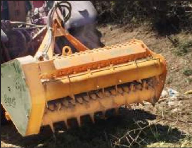
Trituradora con alimentador hidráulico reversible para tractores entre 50 - 70 CV, ideal para viña, uva de mesa, olivos, almendros, cítricos, etc.
