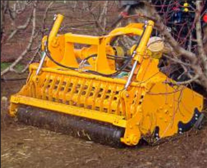
Trituradora polivalente para la eliminación de restos de poda, en cítricos, frutales, olivo y desbroce de materia en pie. Puerta trasera hidráulica con criba, rompedores intercambiables y rodillo de control al suelo.
