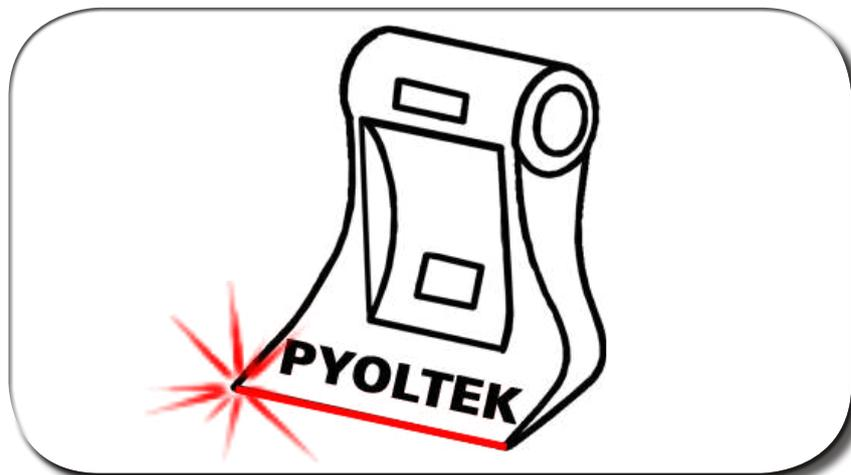
Tratamiento láser en la punta del martillo. Zona de desgaste, alarga su vida útil dando una rentabilidad tanto en el coste horario como en la reducción del tiempo en las paradas para el mantenimiento.
