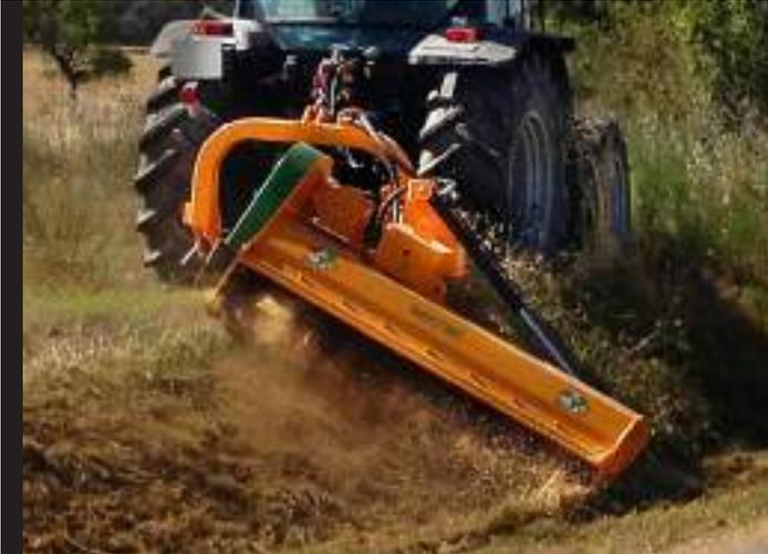
Desbrozadora de alta gama, multiuso polivalente, lateral y posterior, para trabajos en márgenes agrícolas, taludes, autovías, canales, carreteras y demás desbroce de obras públicas para tractores de 70 - 120 CV. Valvula de seguridad contra accidentes. Angulación +90° / -65°. Dos posiciones en puerta trasera. Rotor POLSER de 450 mm de diámetro con martillos de alto filo.
