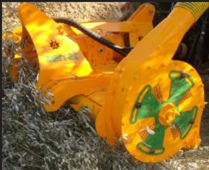
Máquina trituradora recuperadora de madera de poda en frutales, cítricos, viña, etc. para acoplar a tractores a partir de 80 CV o instalar en el tripuntal delantero de un tractor estándar de 130 - 140 CV.
