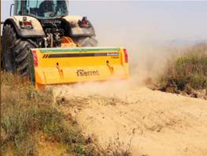
Máquina de preparación de suelo hasta una profundidad de 50 cm, para tractores entre 130 - 150 CV.
