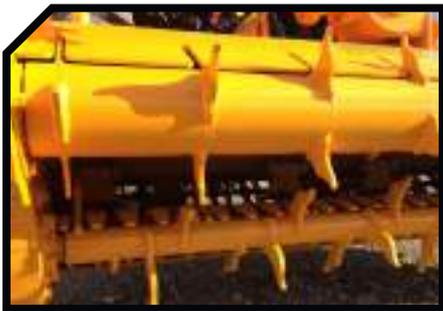
**Turbina de lanzamiento**
