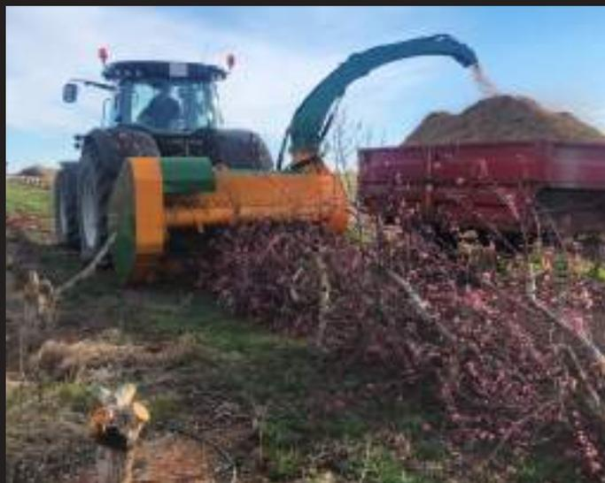
Máquina trituradora recuperadora de madera para acoplar a tractores de más de 300 CV hasta 500 CV. Sistema de arranque HIDRAHELP.
