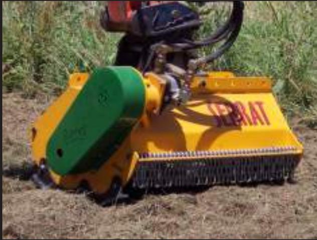
Cabezal adaptable a mini excavadoras entre 3,5 - 6 TM. y sustitución de brazos forestales.
