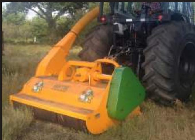
Trituradora BIOGREEN, es una sola pasada, y a la velocidad habitual, es capaz de cortar y lanzar la hierba y matorrales a un contenedor para evacuarlos del terreno.
