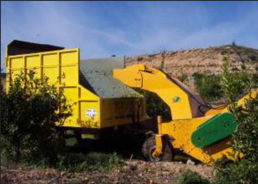
Equipo diseñado para la recogida de residuos de poda en agricultura para su aprovechamiento en posteriores procesos como bio combustible y compostaje.
