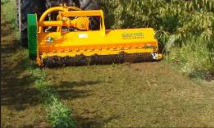
Trituradora de martillos, para la eliminación de restos de poda de hasta 8 cm y mantenimiento del manto vegetal. Ideal para la regeneración de praderas y pastizales.
