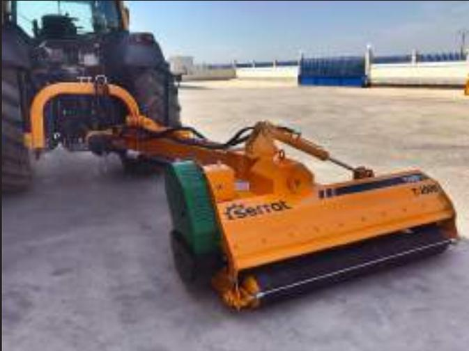
Desbrozadora de alta gama con rotor agrícola, multiuso polivalente, lateral y posterior, para trabajos en márgenes agrícolas, taludes, autovías, canales, carreteras y demás desbroce de obras públicas para tractores de 120 - 160 CV.
