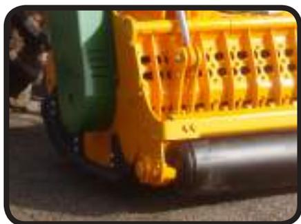
► Puerta trasera hidráulica con criba
