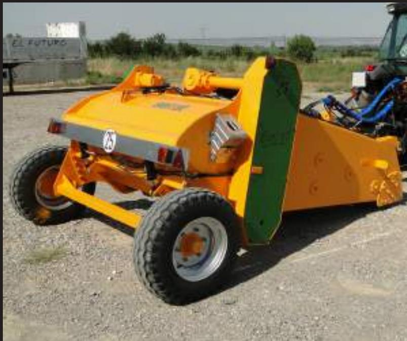
Trituradora de piedras con sistema de carga continua para el calibrado de terrenos de uso agrícola y hortícolas.
