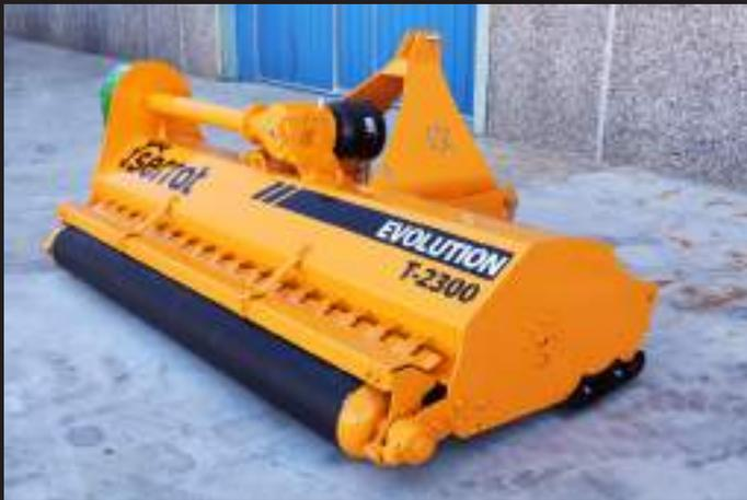
Trituradora de martillos, para la eliminación de restos de poda de hasta 8 cm y mantenimiento del manto vegetal. Ideal para la regeneración de praderas y pastizales.
