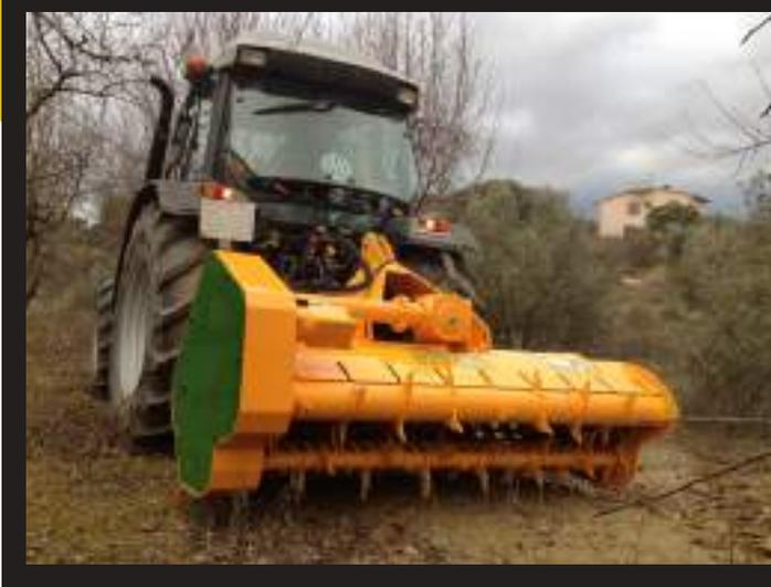
Trituradora con doble triturador hidráulico ideal para restos de olivo, cítricos y frutos secos de hasta 6-8 cm de diámetro, con criba trasera recambiable para determinar la granulometría, para tractores de entre 70 y 120 C.V.
