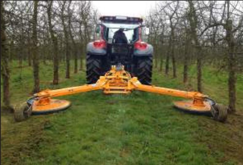
Doble plato de eje vertical con accionamiento mecánico para el mantenimiento de la base de árboles frutales.
