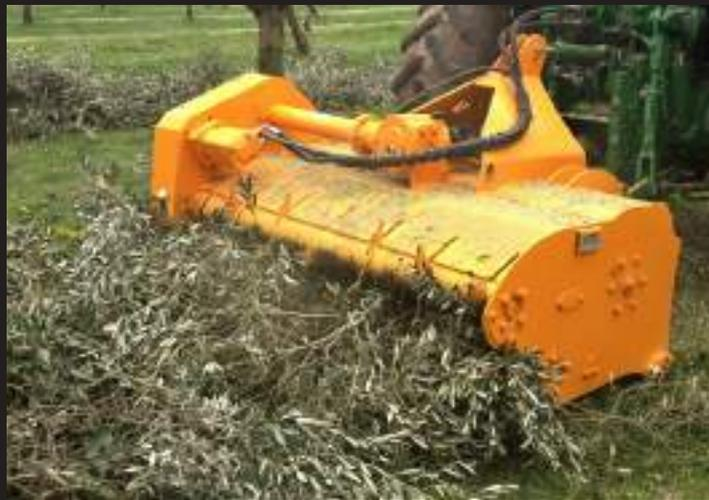
Trituradora con alimentador hidráulico reversible para tractores entre 60 - 120CV, ideal para viña, uva de mesa, olivos, almendros, cítricos, etc.
