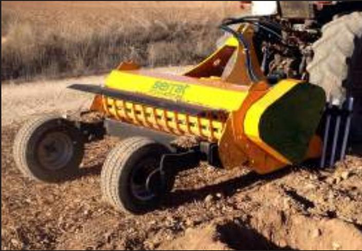
Trituradora con alimentador hidráulico reversible, para restos de viña, olivo, almendros, etc. hasta un diámetro de 5 cm.
