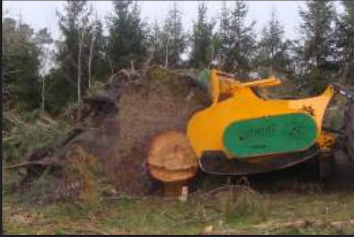
Trituradora forestal adaptable a tractores entre 300 - 600 CV de potencia.
