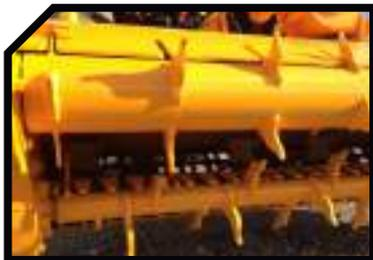
**Criba trasera dentada recambiable**
