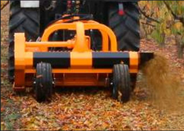
Trituradora con alimentador hidráulico reversible y sistema de acarreo a la base de la plantación, ideal para viña, uva de mesa, olivos, almendros, cítricos, etc. Máquina para trabajos exigentes, con necesidad de depositar restos muy finos como mulching en la base evitando posibles plagas y ayudando a su eliminación, para procesos posteriores. Equipa rotor de cuchillas RHENDUEL.
