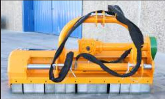
Trituradora diseñada para tractores desde 15 CV a 50 CV de potencia para la agricultura de mantenimiento del manto vegetal y ramas de hasta 3 cm de diámetro.
