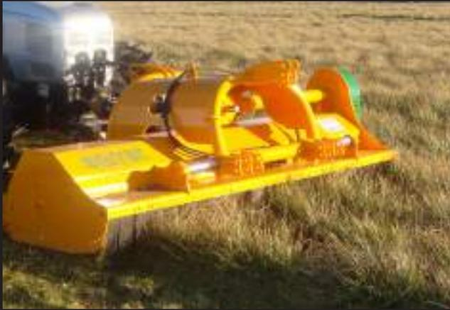
Trituradora de martillos, para la eliminación de restos de poda de hasta 8 cm y mantenimiento del manto vegetal.
