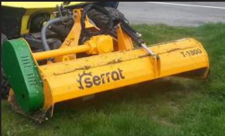
Trituradora diseñada para tractores desde 70 CV a 80 CV de potencia para la agricultura de mantenimiento del manto vegetal y ramas de hasta 5 cm de diámetro.
