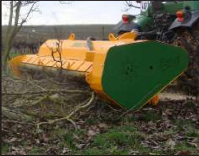
Trituradora con alimentador hidráulico reversible para tractores entre 100 - 160 Cv, ideal para viña, uva de mesa, olivos, almendros, cítricos, etc.
