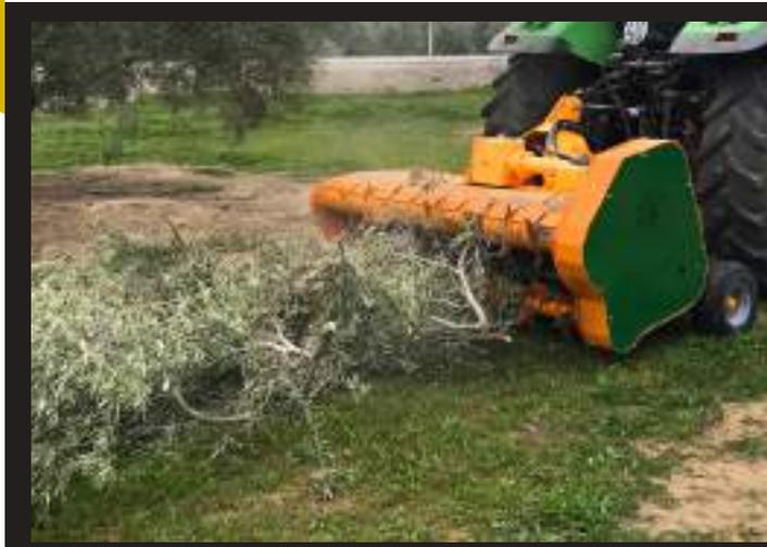
Trituradora con doble alimentador hidráulico ideal para restos de olivo, cítricos y frutos secos de hasta 8-10 cm de diámetro, con el rotor ÓCLAME de SERRAT para tractores de entre 90 y 140 C.V.
