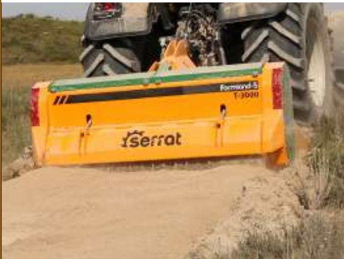
Máquina de preparación de suelo hasta una profundidad de 50 cm, para tractores entre 250 - 500 CV.
