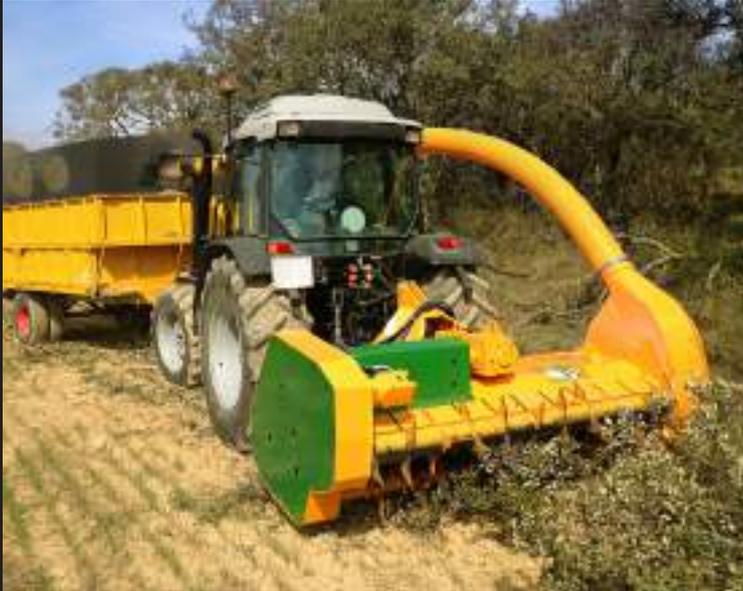
Máquina trituradora recuperadora de madera de poda de olivo, frutos secos y restos forestales, etc. para acoplar a tractores de 100 - 150 CV o instalar en el tripuntal delantero de un tractor estandar de 150 - 170 CV. En el caso del tractor estandar, éste podrá llevar enganchado un remolque en la parte posterior para recepcionar el material que es conducido por un tubo flexible.
