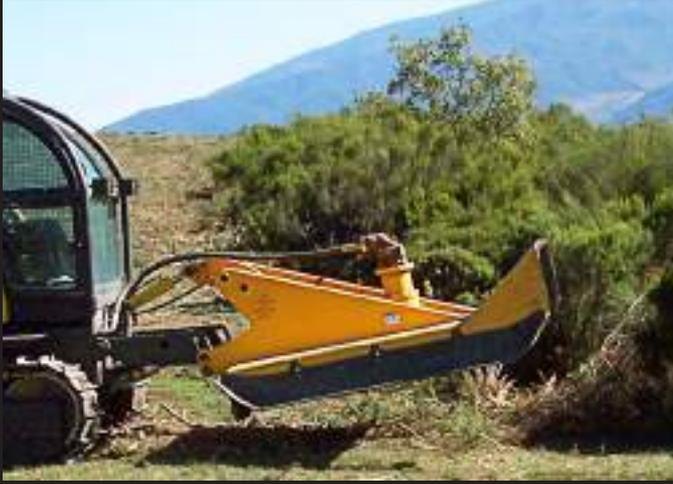
Desbrozadora forestal de cadenas con chasis monocasco en espesor de 15 mm. Grupo hasta 160 CV. Apta para desbroces forestales, creación de pastizales, monte bajo y líneas eléctricas, con matorral en pie hasta 8 cm.
