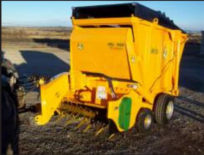
Trituradora versátil en la recogida de podas, ramas en general y sarmientos hasta 5 cm.
