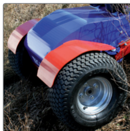
Para el desplazamiento el equipo cuenta con neumáticos de gran anchura con tracción delantera y mucho agarre.
