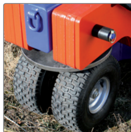
La doble rueda trasera mejora la estabilidad y evita el deslizamiento en suelos húmedos o escurridizos.
