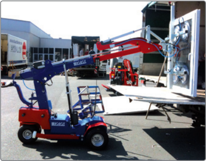
En la figura el KS Robot Cristalero, 400, ofrece 900 mm de telescopaje y hasta 1.320 mm por delante de las ruedas.
