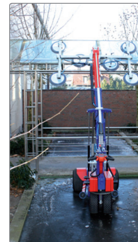
La pluma extensible telescópica hace posible el uso en altura del Robot Cristalero.
