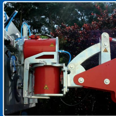
Hidráulico de giro y basculamiento con la HDS-cabeza equipo opcional 270 grados en un círculo y 90 ° a un lado.
