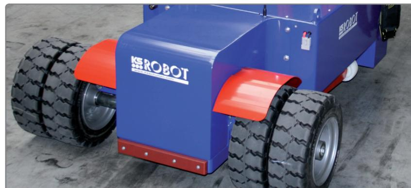
Ajuste del eje para posicionar con precisión los paneles de vidrio y los neumáticos duales para una muy buena estabilidad.
