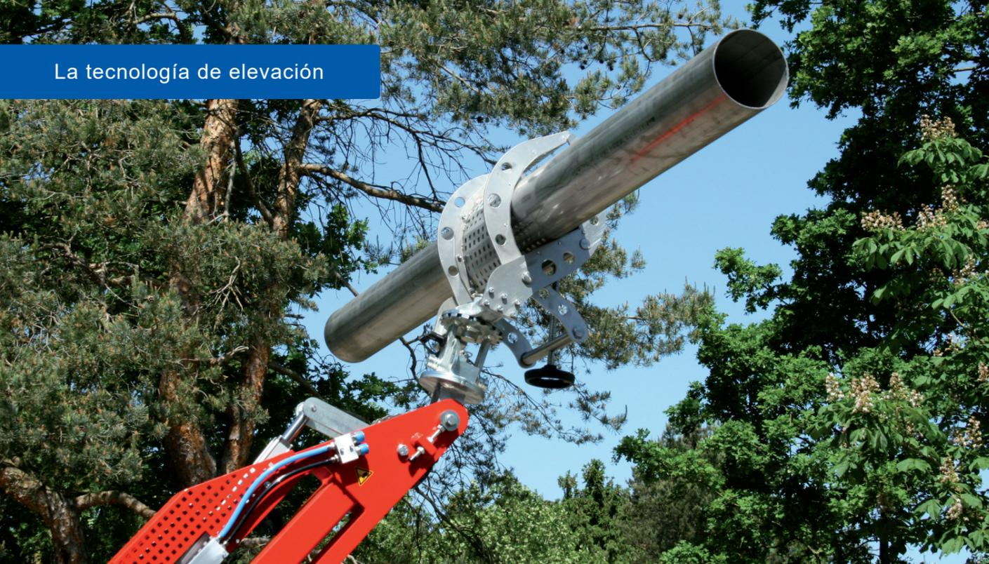
Pinzas especiales para rollos de alfombra, de plástico o tubos de metal eléctrica y mecánicamente posible.
