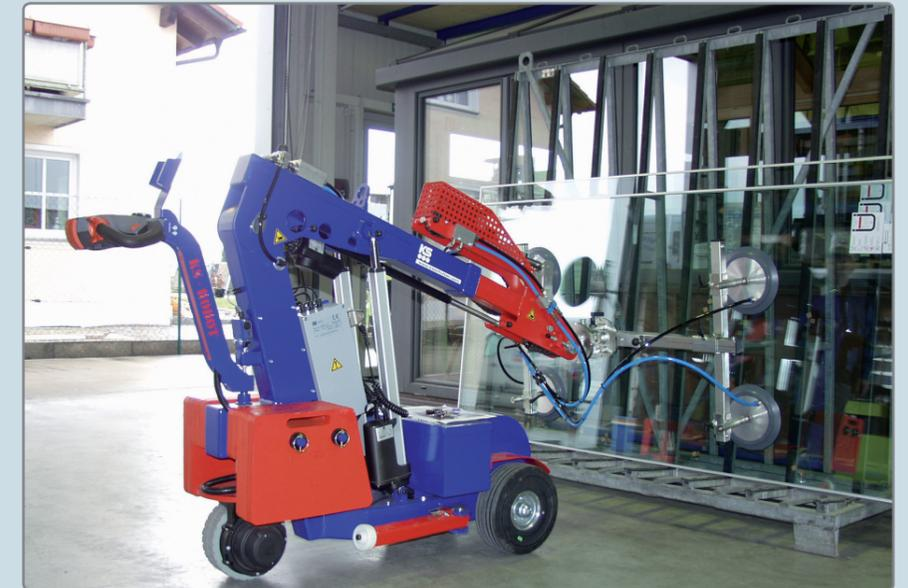
Robot KS 280 para el transporte de hasta 280 kg materiales y para acristalamiento de los elementos de la ventana y de fachada.
