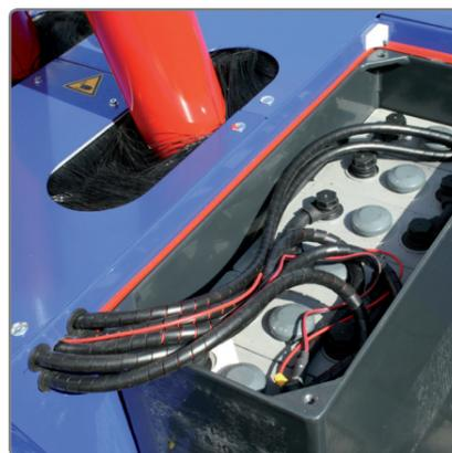
Equipado con intercambiables batería de alto rendimiento para uso en turnos.
