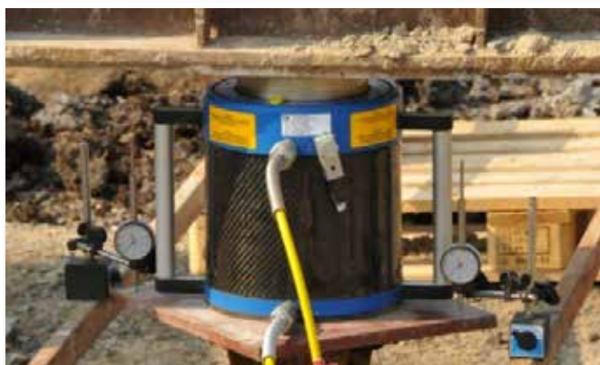
Fig.: Prueba a compresión de un micropilote en un suelo con riesgo de pandeo.
