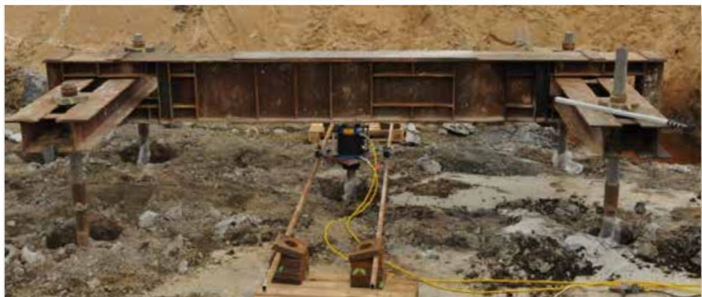
Fig.: Prueba a compresión de un micropilote en un suelo con riesgo de pandeo.
