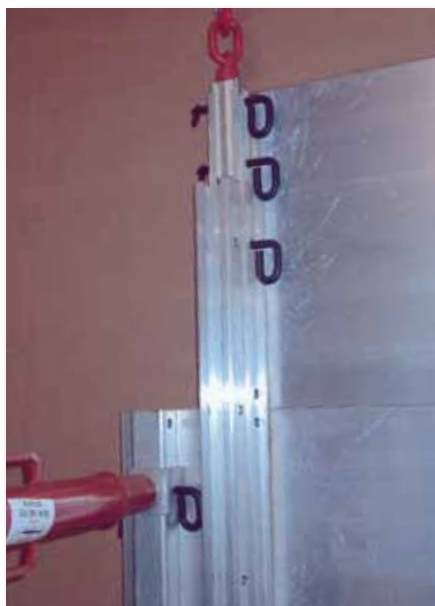
Anillo de carga fijado a la pieza de unión y a la guía deslizante
