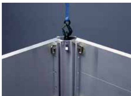
Extracción escalonada de la unión angular para pozos
