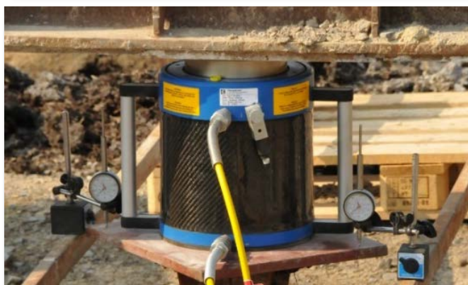
Fig.: Prueba de compresión con micropilotes en suelo con riesgo de pandeo.
