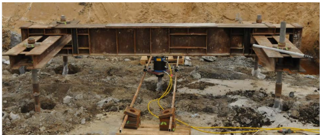
Fig.: Prueba de compresión con micropilotes en suelo con riesgo de pandeo.
