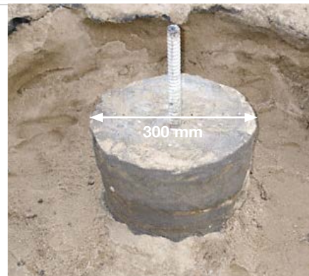
Fig.: Cuerpo inyectado (micropilote TITAN 40/16 con boca de perforación para arcilla \varnothing 110 mm y tobera HM) inyectado con gran presión en arena blanda.
