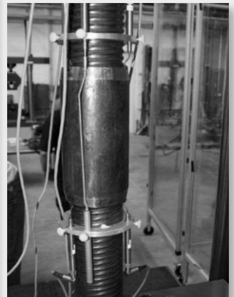
Fig. Ensayos de fatiga por vibraciones en unión con manguito TITAN 103/78 en la Universidad Técnica de Múnich.
