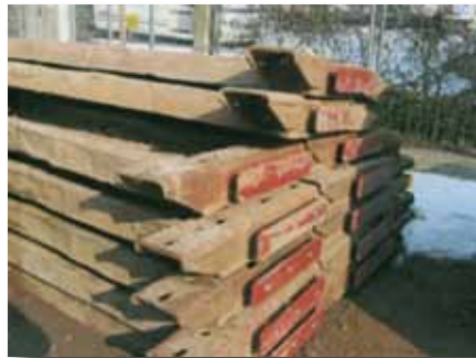
Paneles de entibación y paneles cortantes con patines deslizantes atornillados
