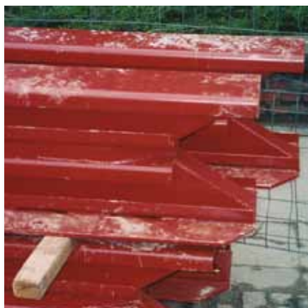
Guías dobles deslizantes con terminación en cuña para facilitar el posicionamiento
