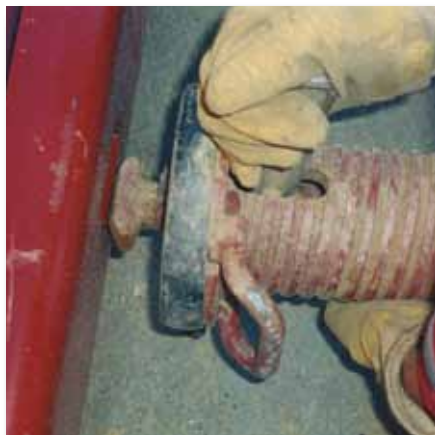
Guías dobles deslizantes con terminación en cuña para facilitar el posicionamiento
