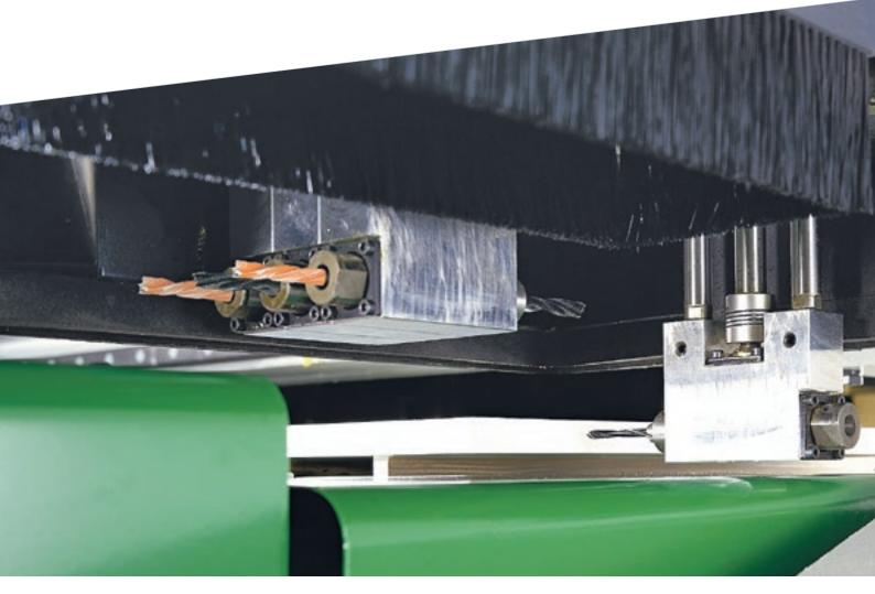
El sistema de topes escamotables permite la accesibilidad completa del lado frontal del panel.
