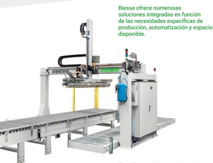
**Winner W3** es una solución automática que permite cargar y descargar tableros en líneas de alta flexibilidad de elaboración para realizar una gestión de las pilas en función de los pedidos.
