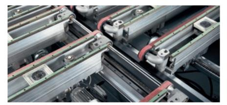
El área de trabajo en versión configurable de modo automático permite la adaptación de las superficies / sistemas de transporte individuales para garantizar siempre la accesibilidad necesaria para los mecanizados que se deben realizar. La implementación de los parámetros de las superficies se realiza en un tiempo muy reducido gracias a la motorización independiente de cada uno de los elementos para garantizar la máxima productividad.
