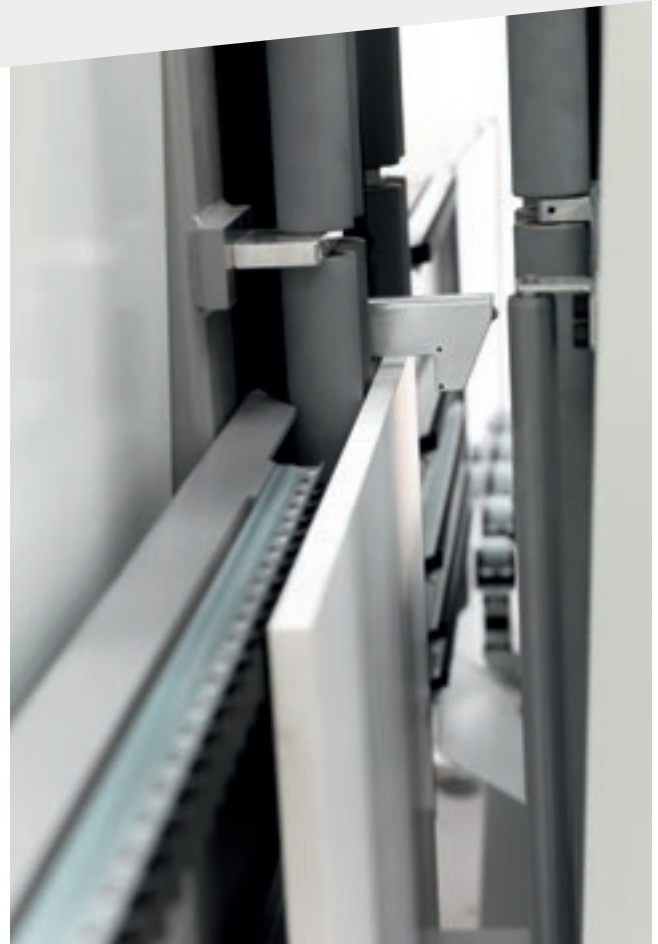
El sistema de lectura superior está constituido por un par de fotocélulas capaces de detectar la altura del panel y efectuar la corrección de la dimensión en relación con el eje "Y".
