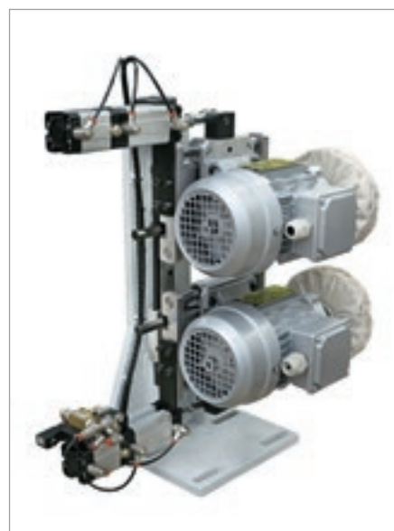
Grupo de cepillos para la limpieza y el pulido del canto y del tablero.
