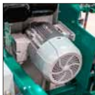
2 motores eléctricos de 11 kW
