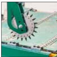
Cadena dentada Los rodillos de sujeción punzantes mantienen el tronco en posición.
