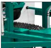
Sistema de alimentación La correa de alimentación con "mesa punzante" sostiene los troncos firmemente en su lugar durante el aserrado.
