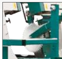
Barras de retención Los rodillos de sujeción de acero punzantes mantienen el tronco en posición.
