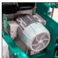
2 motores eléctricos de 11 kW
