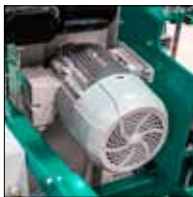
2 motores eléctricos de 11 kW
