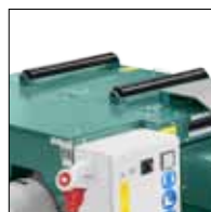
Rodillos superiores Facilitan el retorno de tablas que requieren un segundo agregado.
