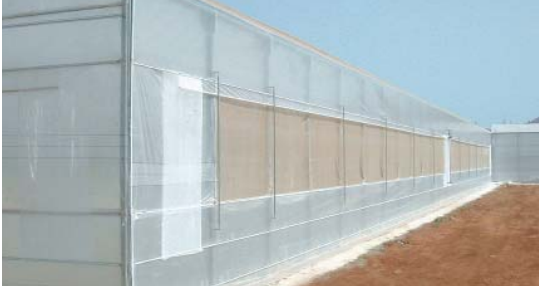
◀ SARAN PENCERE Plastik film ana eksen üzerinde aşağı yukarı sarmaktadır. GİYOTİN PENCERE ▶ Dikine hareket ile açılır.
