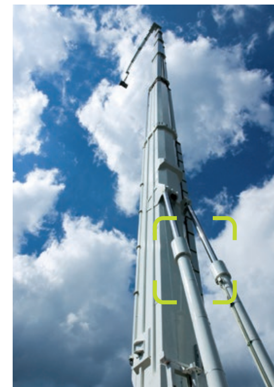
Plataforma elevadora móvil Para asegurar el brazo telescópico de la plataforma de 101 metros de altura
