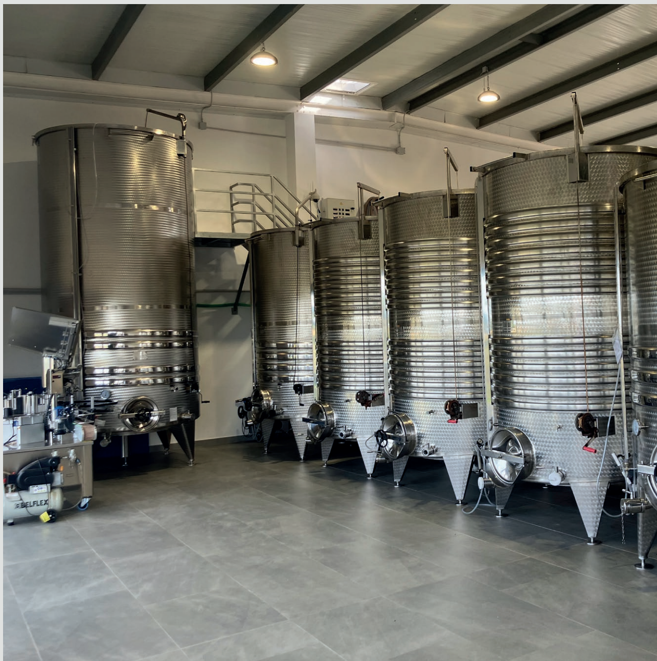
Vinyes Binitord, Menorca. Depósitos FISP con puerta y con camisa. Ver páginas 091, 092, 093.
