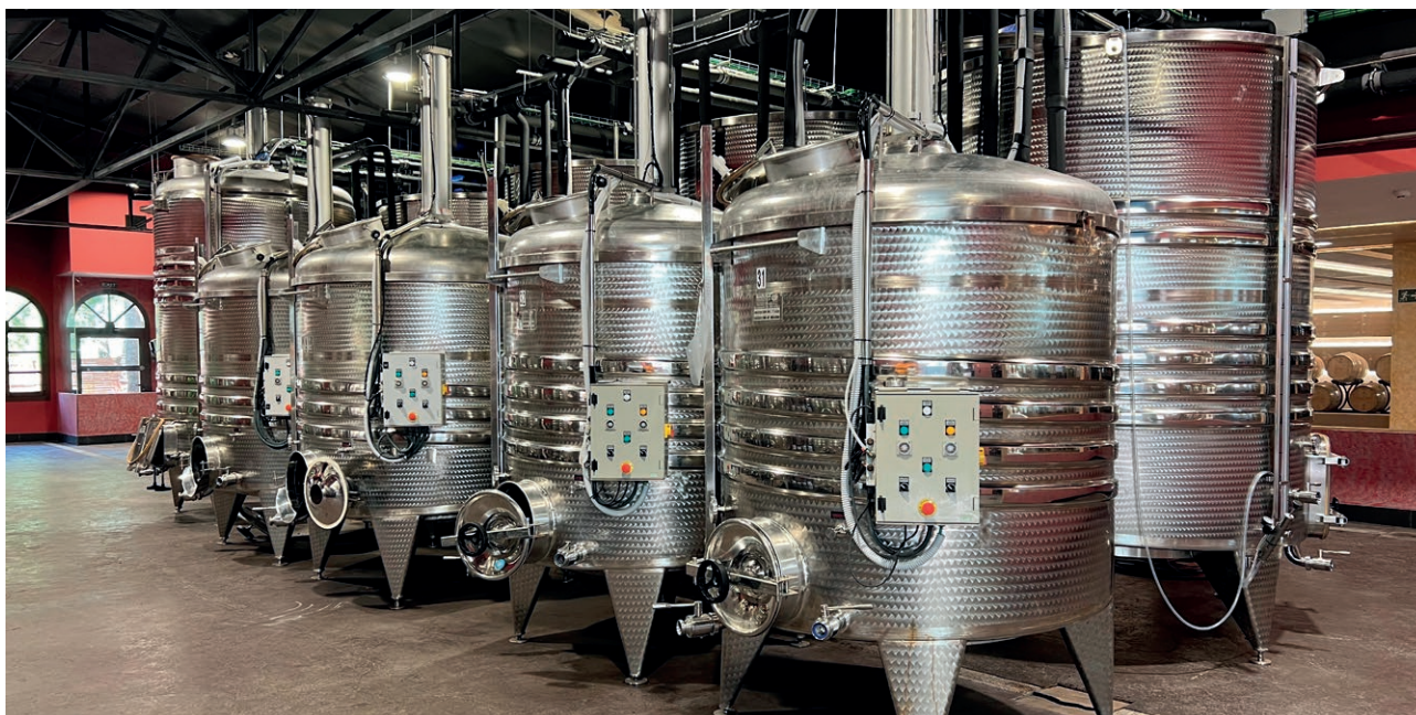
Blanca Terra, Mallorca. Depósitos siempre llenos FISP con puerta y camisa con opción Pigeage. Proyecto especial.
