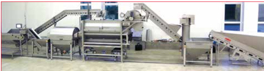
Italia: Proceso de papas/patatas y otros tubérculos, para despedrar, pelar y lavar con una capacidad de hasta 800 kg/hora.
