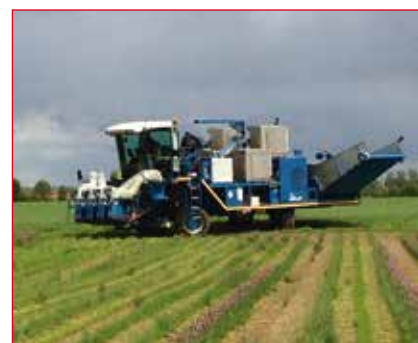
Alemania: Cosecha y corte sobre cosechadora de cebollín, con 4 cortadoras KRONEN GS 20, capacidad hasta 1,8 t/hora.
