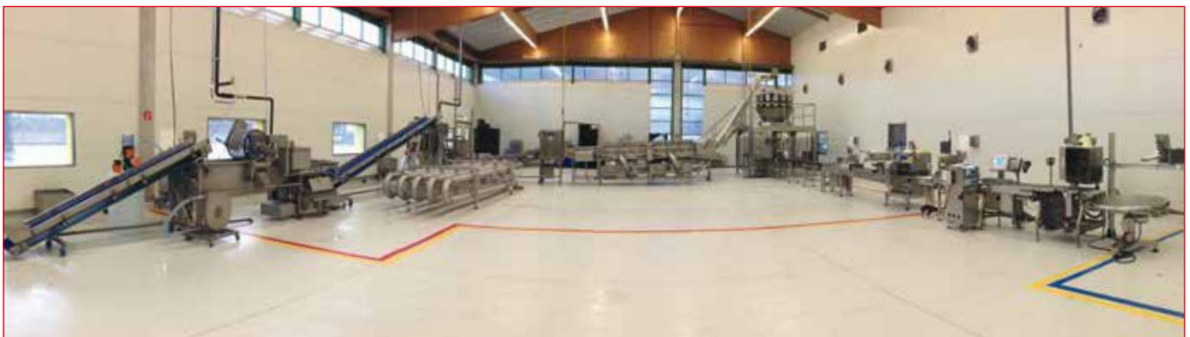
Austria: Línea para preparar, cortar, desinfectar, centrifugar y mezclar vegetales de hojas. – capacidad hasta 500 kg/hora.
