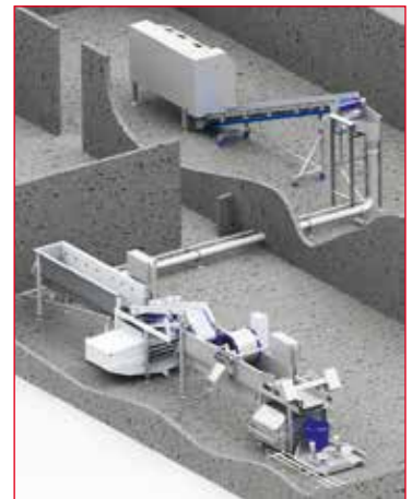
Bélgica: Línea de producción de ensaladas baby leaf y mezclas de hojas delicadas: capacidad 300 a 800 kg/hora
