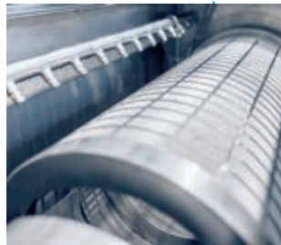
Filtro separador de sólidos
