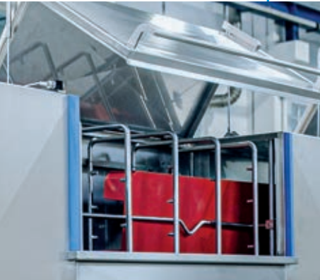
Lavado mediante paneles fijos
