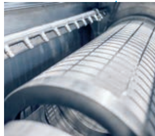
Filtro separador de sólidos
