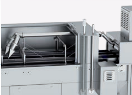
Soplado antes del aclarado para recuperar agua de lavado
