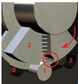
Al intentar forzar la ventana, los tetones de seguridad ① son presionados por un segundo dispositivo de acoplamiento ③ al interior de las entalladuras de la carcasa ②.
