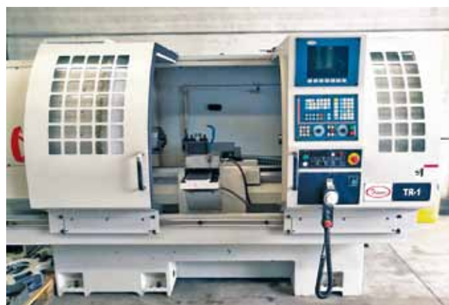
TRAVIS TR-1. CNC FAGOR 8055. E.P. 1000mm. Ø s/bancada 450mm. Bien equipado.
