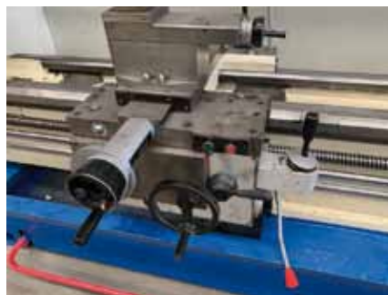
PINACHO S-90/330. E.P. 3250mm. Ø s/bancada 660mm. Ø caña: 105mm. Equipado con: Plato universal 3 garras reversibles Ø 310mm. Torreta. Carro motorizado. Luneta.
