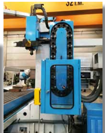
SORALUCE TR-35. CNC HEIDENHAIN TNC 426. Mesa: 3860x1200mm. Recorridos: 3500x1200x1600mm. Cabezal automático 2,5°-2,5°. Cargador ATC 30 herramientas. Extractor de virutas.
