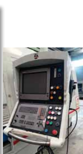
SORALUCE TR-35. CNC HEIDENHAIN TNC 426. Mesa: 3860x1200mm. Recorridos: 3500x1200x1600mm. Cabezal automático 2,5°-2,5°. Cargador ATC 30 herramientas. Extractor de virutas.
