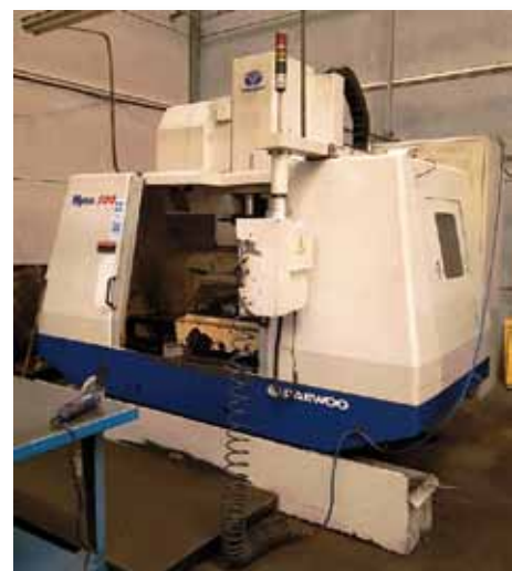
DAEWOO MYNX 500. CNC FANUC SERIE 21 iM. Recorridos: 1020x510x625mm. Cargador 24 htas. refrigeración interna. DAEWOO MYNX 500. CNC FANUC SERIE 21 iM. Travels: 1020x510x625mm. Tool changer 24 units. Inner cooling.
