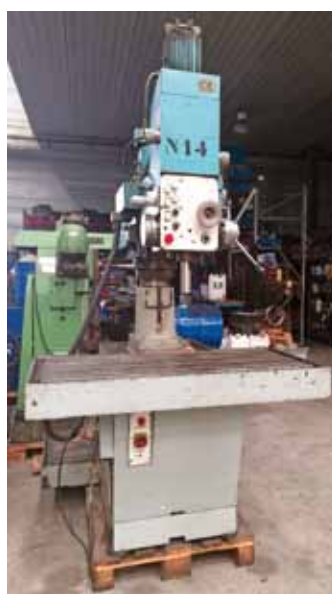
Taladro radial IRSA. Mesa: 1300x650mm Capacidad de trabajo: 32mm IRSA radial drill. Table: 1300x650mm Drilling capacity: 32mm
