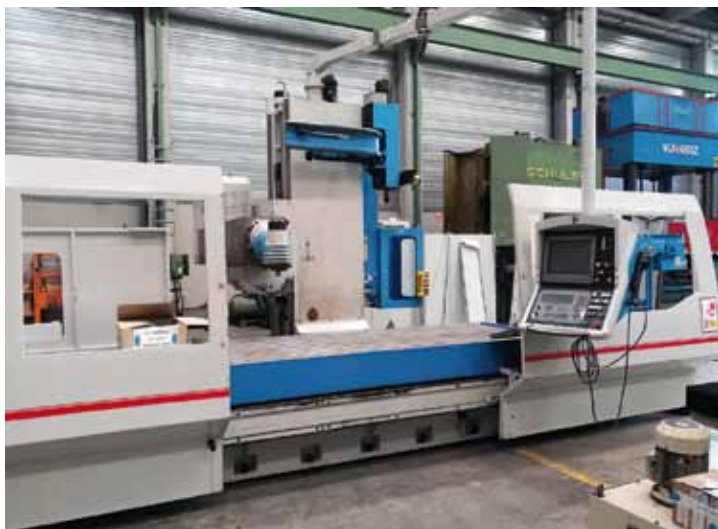
SORALUCE TR-35. CNC HEIDENHAIN TNC 426. Mesa: 3860x1200mm. Recorridos: 3500x1200x1600mm. Cabezal automático 2,5°-2,5°. Cargador ATC 30 herramientas. Extractor de virutas.
