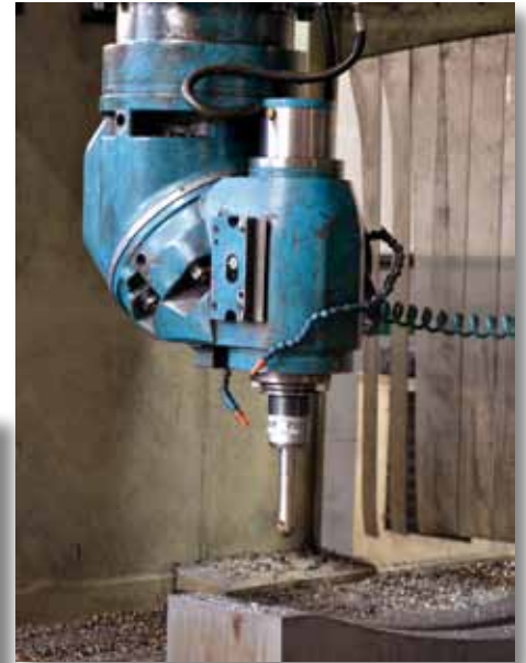
NICOLAS CORREA FP-30/40. CNC HEIDENHAIN 426. Mesa: 4000x1250mm. Recorridos: 3500x2300x800mm. Cabezal HURON manual y cabezal salida directa. Normativa CE
