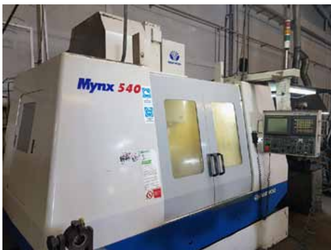
DAEWOO MYNX 540. CNC FANUC SERIE 21 iM (Digital). Recorridos: 1020x510x625mm. Cargador 24 htas. refrigeración interna. DAEWOO MYNX 540. CNC FANUC SERIE 21 iM (Digital). Travels: 1020x510x625mm. Tool changer 24 units. Inner cooling.
