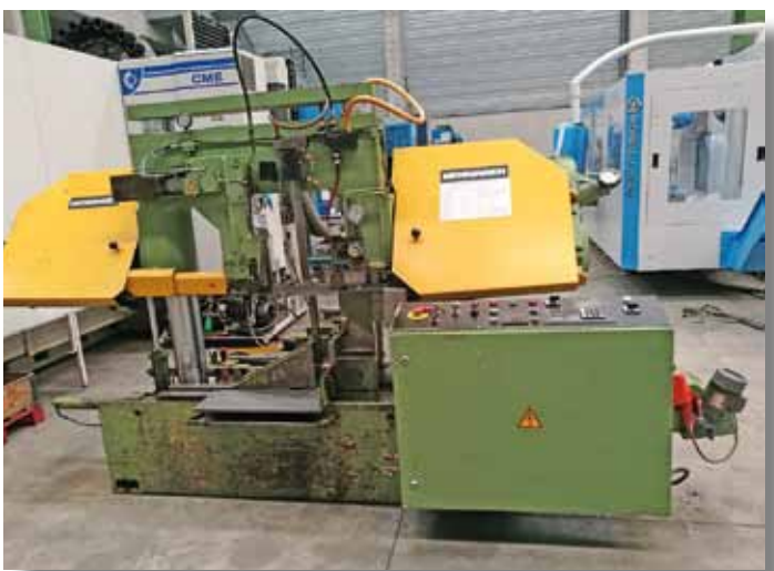
Sierra cinta automática BEHRINGER HBP 420A . Capacidad de corte: 420mm (redondo) 420x420mm (cuadrado). Velocidad: 17-110 m/min. BEHRINGER HBP 420A automatic bandsaw. Cutting capacity: 420mm (round) 420x420mm (square). Cutting speed: 17-110 m/min.
