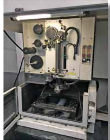
FANUC ROBOCUT ALPHA-0iB. Recorridos: X 320mm Y 220mm U 120mm V 120mm Z 180mm. Dimensiones pieza: 600x400x180mm. Año 2001.
