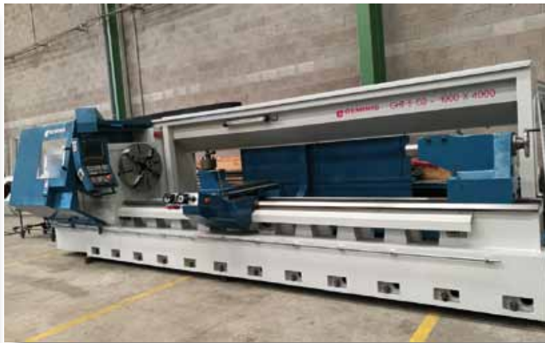
GEMINIS GHT5 G2. CNC SIEMENS 810 D. E.P. 4000mm. Ø s/bancada 1000mm. Torreta manual. Refrigeración interna. Extractor de virutas. Año 2009.
