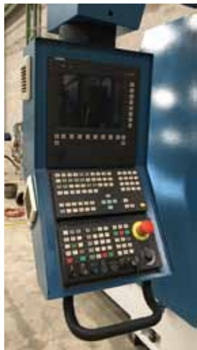
GEMINIS GHT5 G2. CNC SIEMENS 810 D. E.P. 4000mm. Ø s/bancada 1000mm. Torreta manual. Refrigeración interna. Extractor de virutas. Año 2009.
