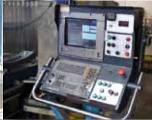
NICOLAS CORREA FP-30/40. CNC HEIDENHAIN 426. Mesa: 4000x1250mm. Recorridos: 3500x2300x800mm. Cabezal HURON manual y cabezal salida directa. Normativa CE
