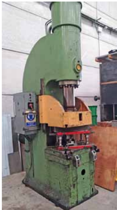
Prensa hidráulica GUILLEM GALDABINI cuello de cisne 80-100 Tn con cojín GUILLEM GALDABINI hydraulic throat press 80-100 Tn with cushion
