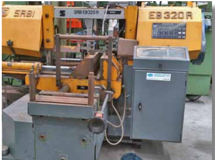
Sierra cinta automática SABI EB 320A . Capacidad corte: 320x320mm. Dimensiones cinta: 4570x32x1,1mm. Velocidad: 16-100 m/min. SABI EB 320A automatic bandsaw. Cutting capacity: 320x320mm. Band dimensions: 4570x32x1.1mm. Cutting speed: 16-100 m/min.
