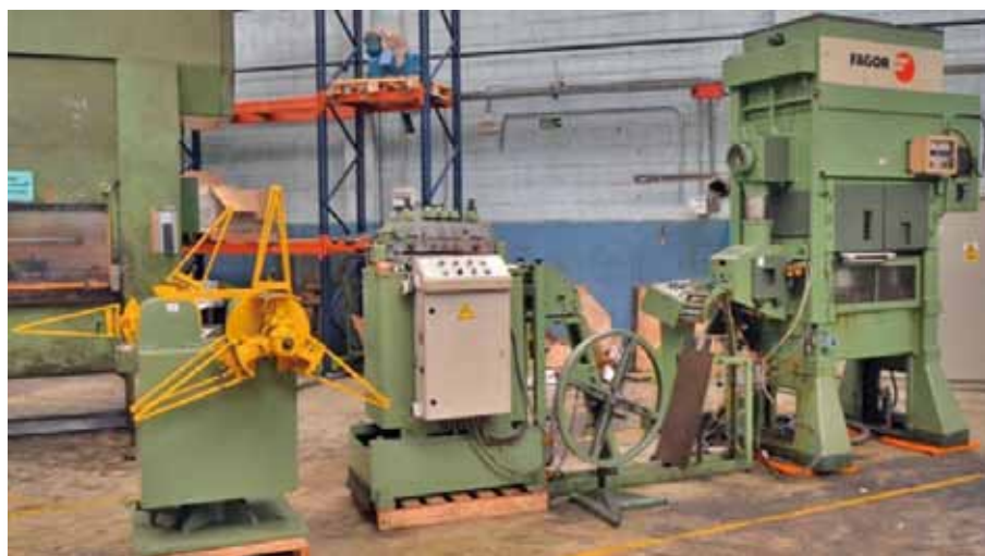
Prensa excéntrica FAGOR HR 60/900 60 Tn. Mesa: 900x530mm. 120-600 g.p.m. Alimentador. Devanadora LASA. Aplanador. FAGOR HR 60/900 eccentric press 60 Tn. Table: 900x530mm. 120-600 s.p.m. Feeder. LASA winder. Planner.
