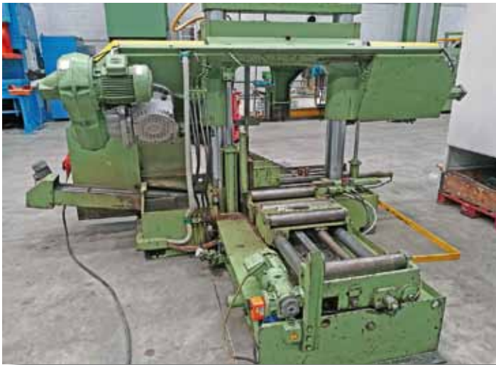
Sierra cinta automática BEHRINGER HBP 420A . Capacidad de corte: 420mm (redondo) 420x420mm (cuadrado). Velocidad: 17-110 m/min. BEHRINGER HBP 420A automatic bandsaw. Cutting capacity: 420mm (round) 420x420mm (square). Cutting speed: 17-110 m/min.
