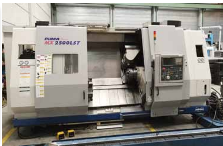
DOOSAN (DAEWOO) PUMA MX 2500 LST – Multitarea - 9 Ejes. CNC FANUC 18i-TB. E.P. 1520 mm. Ø s/ bancada 750 mm. Cabezal fresador. Torreta motorizada. ATC 40 htas. Extractor de virutas. Juegos de herramientas motorizadas.
