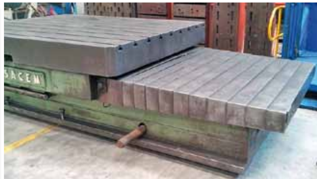
Mesa rototraslante SACEM MGL-2500 . Dimensiones: 2500x2000mm. Recorrido longitudinal: 2100mm. Peso máx sobre mesa: 20 Tn. SACEM MGL-2500 rototraslating table. Dimensions: 2500x2000mm. Longitudinal travel: 2100mm. Max allowed weight on table: 20 Tn.
