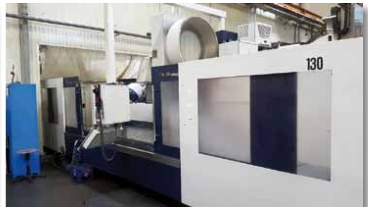
SORALUCE TA-35. CNC HEIDENHAIN iTNC 530. Mesa: 3700x1000mm. Recorridos: 3500x1200x1250mm. Cabezal automático 2,5°-2,5°. Cargador 20 herramientas. 2 extractores de virutas. Carenado perimetral. Año 2009.
