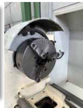
PINACHO S-90/330. E.P. 3250mm. Ø s/bancada 660mm. Ø caña: 105mm. Equipado con: Plato universal 3 garras reversibles Ø 310mm. Torreta. Carro motorizado. Luneta.
