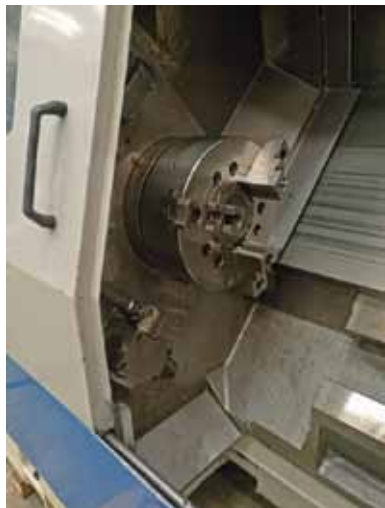
DAEWOO PUMA 400 LMB. CNC FANUC 21iTB. E.P. 2000mm. Ø s/bancada 700mm. Plato y luneta hidráulico SMW AUTOBLOCK. Torreta motorizada. Eje C 100 1/min.
