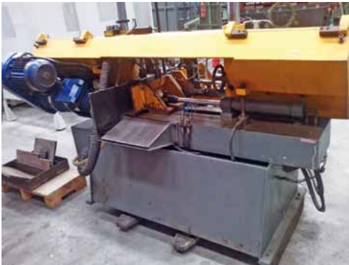
Sierra cinta automática SABI EB 320A . Capacidad corte: 320x320mm. Dimensiones cinta: 4570x32x1,1mm. Velocidad: 16-100 m/min. SABI EB 320A automatic bandsaw. Cutting capacity: 320x320mm. Band dimensions: 4570x32x1.1mm. Cutting speed: 16-100 m/min.
