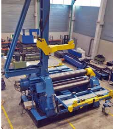
Cilindro 4 rodillos SERTOM-CASANOVAS . Longitud 3050mm. Curvado 50mm. Pre-curvado 32mm. CN. Bandera hidráulica SIAM . Preparada para conificar. SERTOM-CASANOVAS plate bending machine of 4 rolls. Bending 50mm. Pre-bending 32mm. CN. SIAM hydraulic L-rafter. Suitable for making conical shapes.
