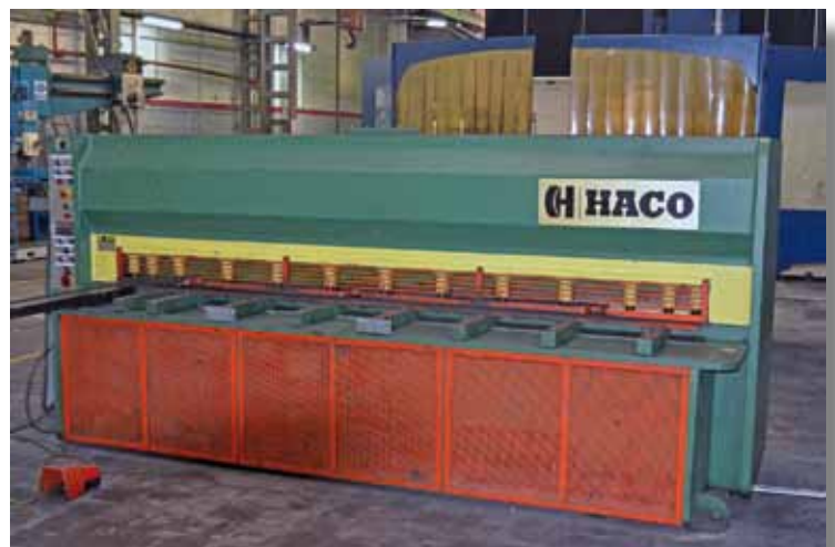
Cizalla mecánica con embrague electro-neumático HACO MS3004 3050x4mm. Lectura digital del tope trasero. HACO MS3004 mechanical shear with electro-pneumatic clutch. 3050x4mm. Digital readout of the backgauge.
