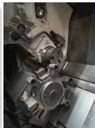
DOOSAN (DAEWOO) PUMA MX 2500 LST – Multitarea - 9 Ejes. CNC FANUC 18i-TB. E.P. 1520 mm. Ø s/ bancada 750 mm. Cabezal fresador. Torreta motorizada. ATC 40 htas. Extractor de virutas. Juegos de herramientas motorizadas.
