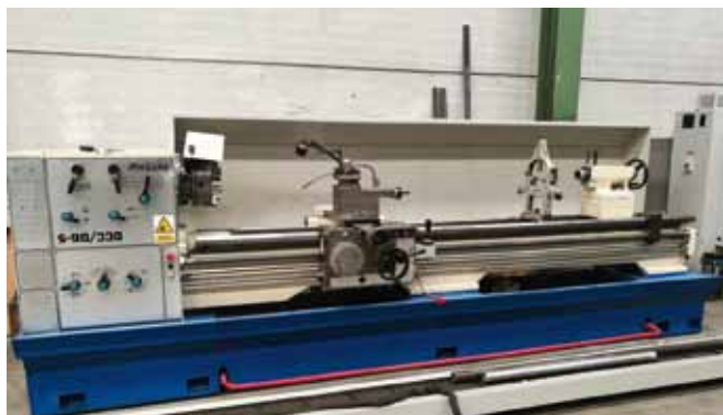
PINACHO S-90/330. E.P. 3250mm. Ø s/bancada 660mm. Ø caña: 105mm. Equipado con: Plato universal 3 garras reversibles Ø 310mm. Torreta. Carro motorizado. Luneta.
