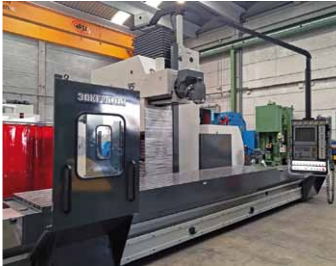
ZAYER 30KF-5000. CNC HEIDENHAIN TNC 426. Mesa: 5000x1000mm. Recorridos: 4710x1508x2013mm. Cabezal automático 45° (0,001°-0,001°). Extractor de virutas.
