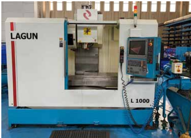
LAGUN L-1000. CNC HEIDENHAIN iTNC 530. Mesa: 1070x510mm. Recorridos: 1020x510x510mm. Cargador 24 herramientas. LAGUN L-1000. CNC HEIDENHAIN iTNC 530. Table: 1070x510mm. Travels: 1020x510x510mm. Tool changer 24 units.
