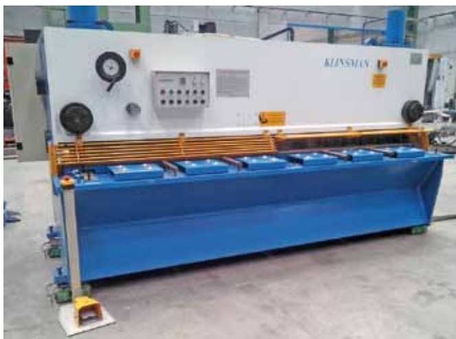
Cizalla hidráulica KLINSMAN RPG 3106 . 3100X6mm. Corte vertical, ángulo variable y tope motorizado. Año 2006. KLINSMAN RPG 3106 hydraulic shear. Vertical cutting, variable angle and motorized backgauge. Year 2006.
