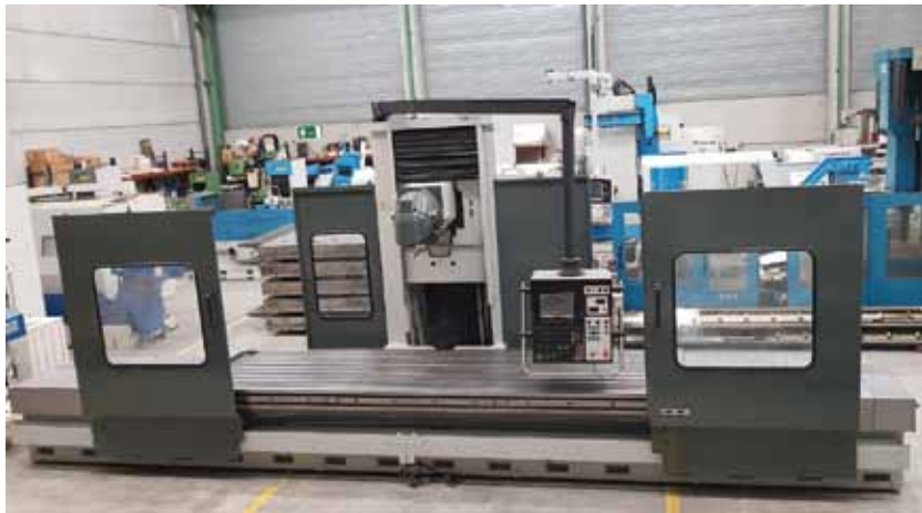
NICOLAS CORREA A30/40. CNC HEIDENHAIN TNC 426. Mesa: 4500x1100mm. Recorridos: 4000x1250x1500mm. Cabezal automático 3°-3°.
