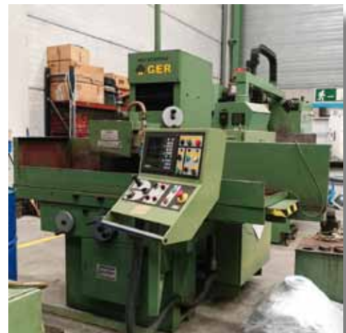
GER S-60/40. CNC FAGOR. Recorridos: 660x400mm. Plato magnético de polo fino: 600x410mm. GER S-60/40. CNC FAGOR. Travels: 660x400mm. Fine pole magnetic chuck: 600x410mm.
