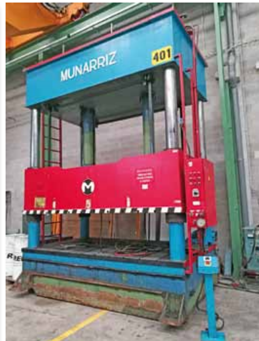
Prensa hidráulica MUNARRIZ 125 Tn. Mesa y carro 3550x2000mm. MUNARRIZ 125 Tn hydraulic press Table and carriage 3550x2000mm.
