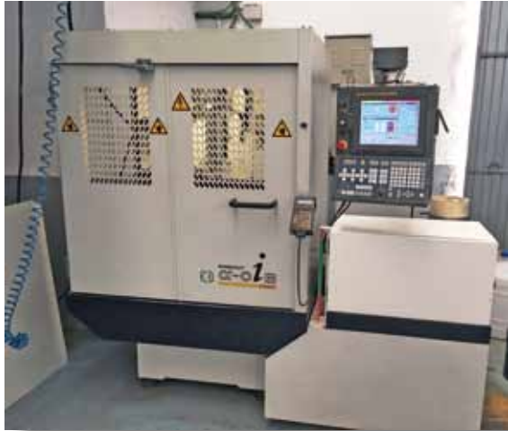
FANUC ROBOCUT ALPHA-0iB. Recorridos: X 320mm Y 220mm U 120mm V 120mm Z 180mm. Dimensiones pieza: 600x400x180mm. Año 2001.
