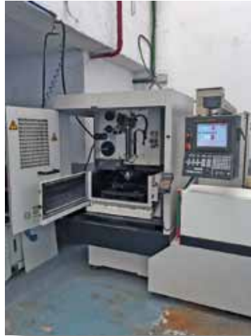
FANUC ROBOCUT ALPHA-0iB. Recorridos: X 320mm Y 220mm U 120mm V 120mm Z 180mm. Dimensiones pieza: 600x400x180mm. Año 2001.
