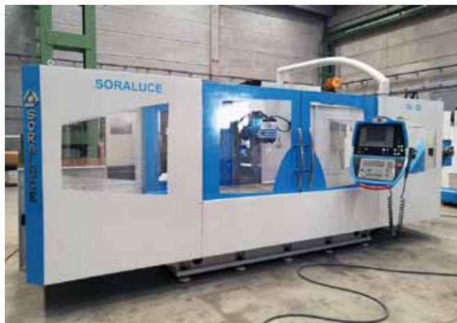
SORALUCE TA-20. CNC HEIDENHAIN TNC 426. Mesa: 2000x800mm. Recorridos: 2000x800x800mm. Extractor de virutas. Carenado perimetral.
