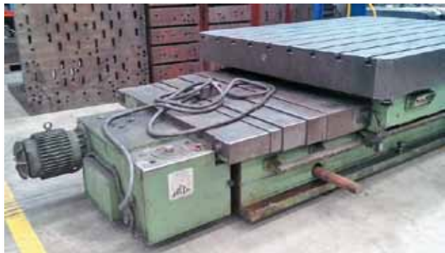
Mesa rototraslante SACEM MGL-2500 . Dimensiones: 2500x2000mm. Recorrido longitudinal: 2100mm. Peso máx sobre mesa: 20 Tn. SACEM MGL-2500 rototraslating table. Dimensions: 2500x2000mm. Longitudinal travel: 2100mm. Max allowed weight on table: 20 Tn.
