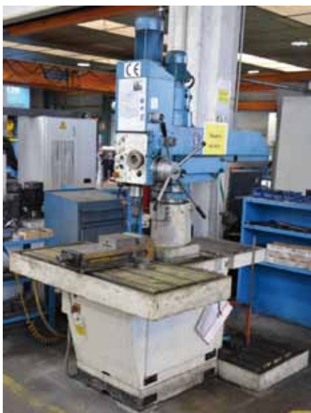
Taladro radial EBA. Mesa: 1300x650mm Capacidad de trabajo: 32mm EBA radial drill. Table: 1300x650mm Drilling capacity: 32mm
