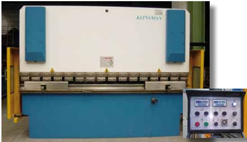
Plegadora hidráulica KLINSMAN RPP 125/320 . 3200X125 Tn. Digitales SIKO . Año 2006. KLINSMAN RPP 125/320 hydraulic press brake. 3200x125 Tn. SIKO display. Year 2006.
