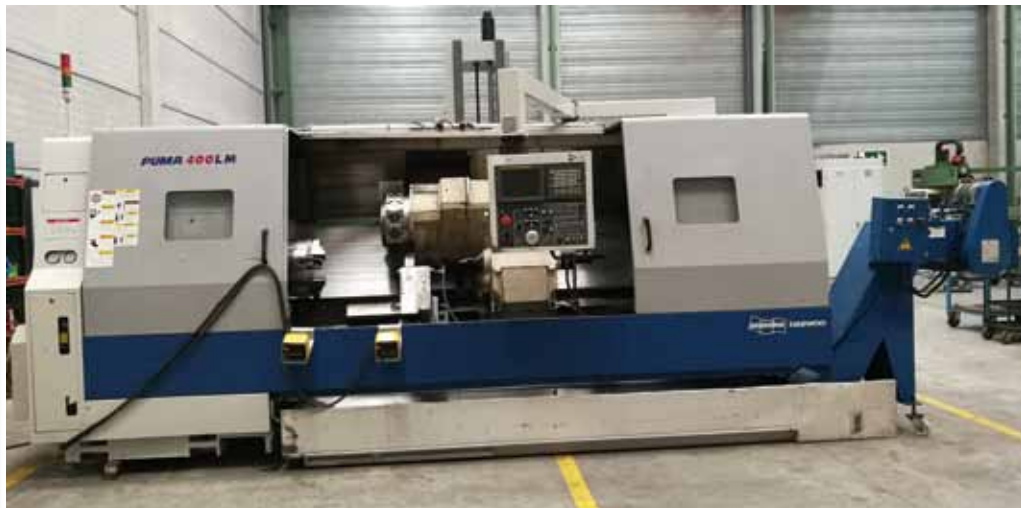
DAEWOO PUMA 400 LMB. CNC FANUC 21iTB. E.P. 2000mm. Ø s/bancada 700mm. Plato y luneta hidráulico SMW AUTOBLOCK. Torreta motorizada. Eje C 100 1/min.
