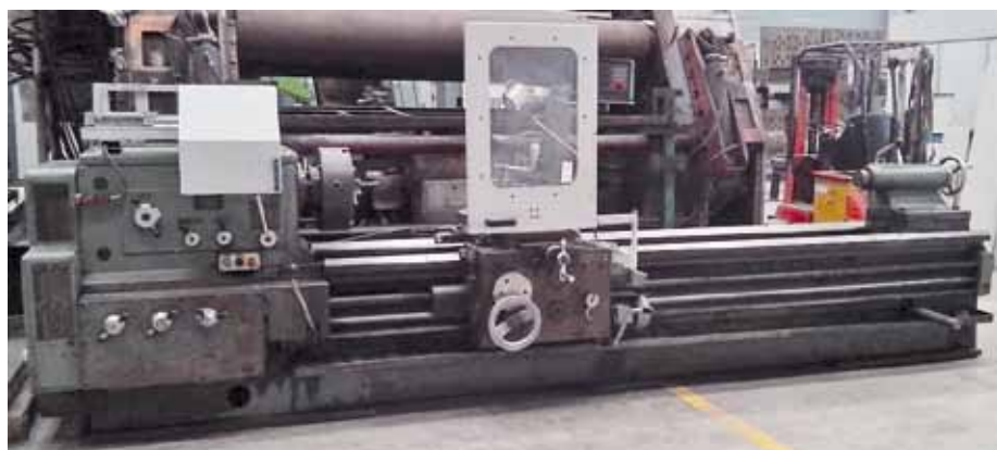
STANKO 1M63B. E.P. 3000 x Ø 630mm. Ø eje principal 72mm. Digitales FAGOR. Bien equipado. Normativa CE.
