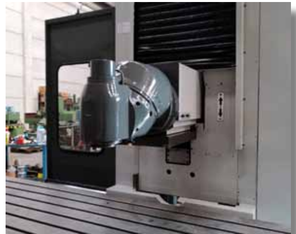
NICOLAS CORREA A30/40. CNC HEIDENHAIN TNC 426. Mesa: 4500x1100mm. Recorridos: 4000x1250x1500mm. Cabezal automático 3°-3°.
