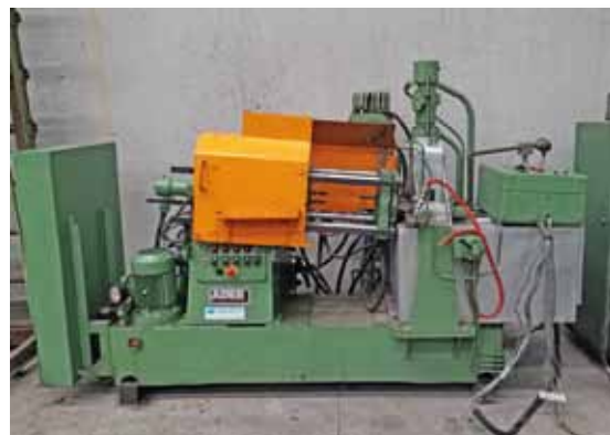
Inyectora de cámara caliente ADER 25 Tn. ADER 25 Tn. Hot chamber die casting machine.
