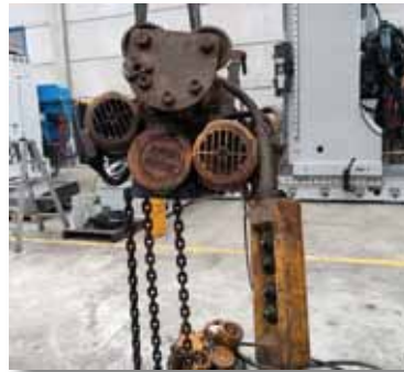
Polipastos eléctricos. Capacidad: 500-2.000 Kgs Electric hoists. Capacity: 500-2,000 kgs
