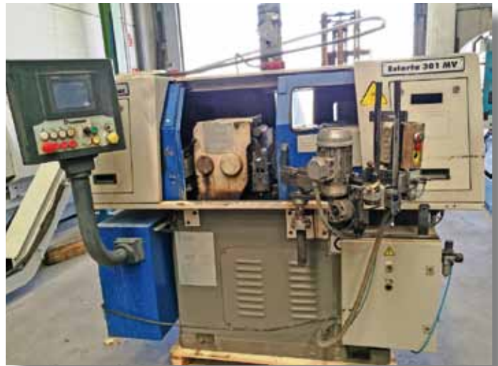
Sin centros ESTARTA 301MV (3 unidades). CNC FANUC . Rectificado en plongeé y rectificado en pasante. Centerless ESTARTA 301 MV (3 units). CNC FANUC . In-feed grinding and through feed grinding.
