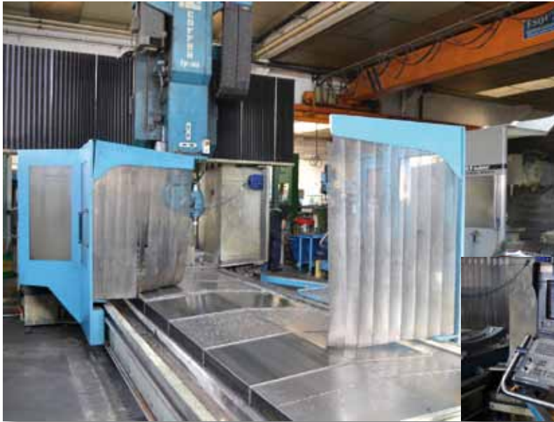
NICOLAS CORREA FP-30/40. CNC HEIDENHAIN 426. Mesa: 4000x1250mm. Recorridos: 3500x2300x800mm. Cabezal HURON manual y cabezal salida directa. Normativa CE
