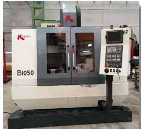
KONDIA B-1050. CNC FANUC 21i-M. Mesa: 1200x500mm. Recorridos: 1000x500x610mm. Plato divisor SPIRSIN (4º eje) KONDIA B-1050. CNC FANUC 21i-M. Table: 1200x500mm. Travels: 1000x500x610mm. SPIRSIN indexing table (4th axis)
