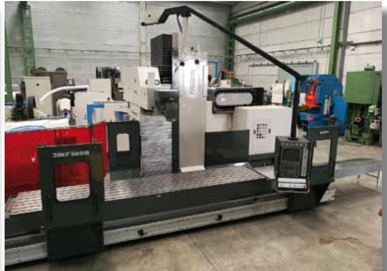
ZAYER 30KF-5000. CNC HEIDENHAIN TNC 426. Mesa: 5000x1000mm. Recorridos: 4710x1508x2013mm. Cabezal automático 45° (0,001°-0,001°). Extractor de virutas.
