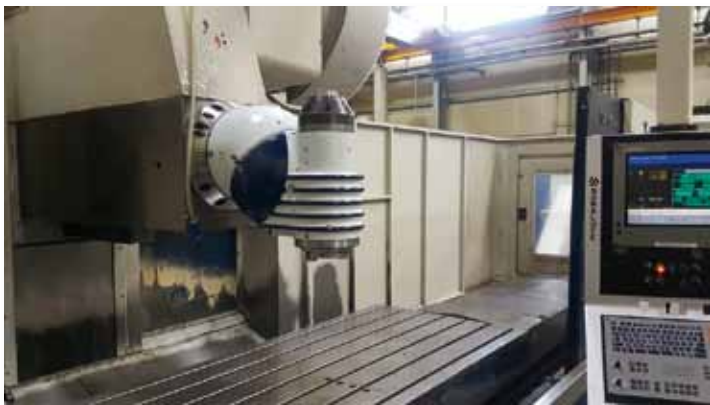
SORALUCE TA-35. CNC HEIDENHAIN iTNC 530. Mesa: 3700x1000mm. Recorridos: 3500x1200x1250mm. Cabezal automático 2,5°-2,5°. Cargador 20 herramientas. 2 extractores de virutas. Carenado perimetral. Año 2009.
