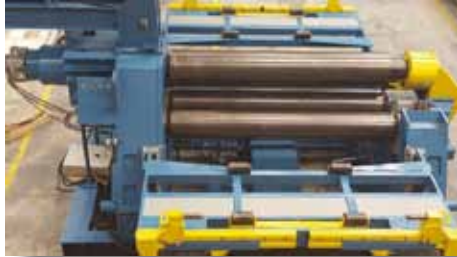
Cilindro 4 rodillos SERTOM-CASANOVAS . Longitud 3050mm. Curvado 50mm. Pre-curvado 32mm. CN. Bandera hidráulica SIAM . Preparada para conificar. SERTOM-CASANOVAS plate bending machine of 4 rolls. Bending 50mm. Pre-bending 32mm. CN. SIAM hydraulic L-rafter. Suitable for making conical shapes.
