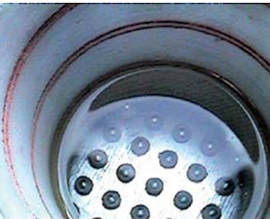
Prueba de la estanqueidad de la cabeza de cierre en 30 mm de columna de agua durante 60 minutos
