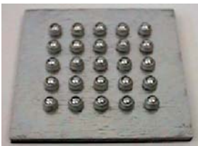
Prueba en placa con 25 remaches pertenecientes al mismo lote de producción
