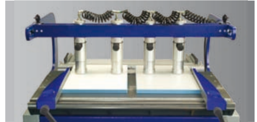
A petición: Cilindro de presión suplementario, altura de sujeción máxima 65 mm. (15.0.311)
