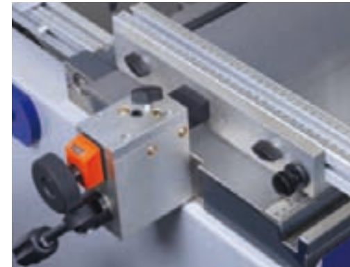
A petición: Tope lateral pivotante con indicador digital (a la izquierda 15.0.319, a la derecha 15.0.320)
