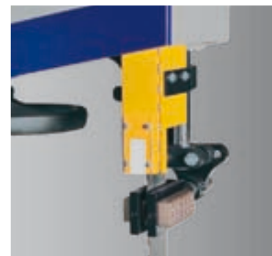
Guiados superiores e inferiores con elementos de bronce (opción)
