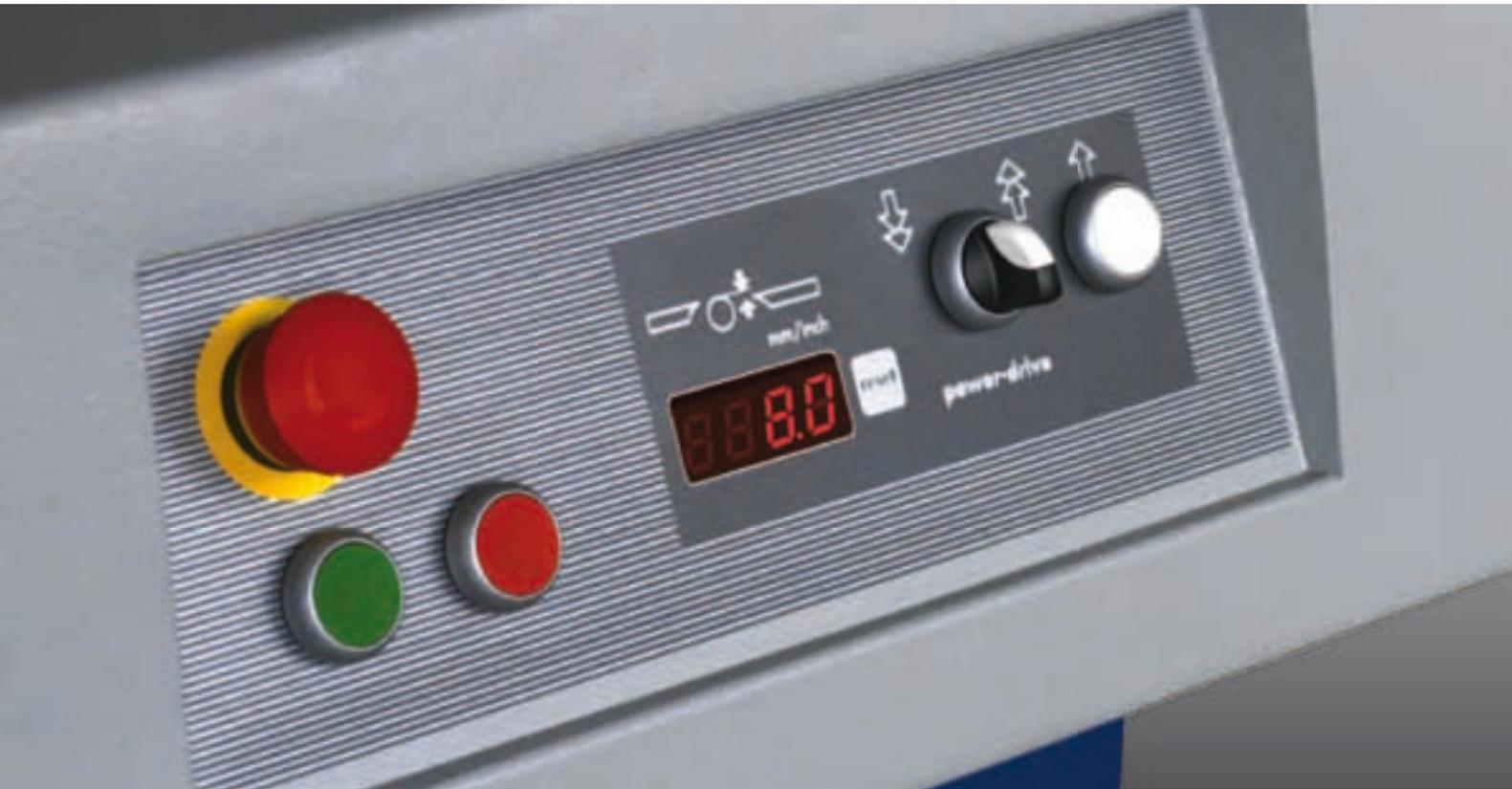
Precisión y comodidad. Desde el lado de manejo se determina el paso de viruta en la mesa de entrada con precisión y comodidad.
