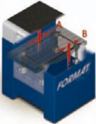
4 husillos de rosca trapezoidal garantizan un ajuste preciso y una alta estabilidad de la mesa de regueso. Lateralmente se desliza la mesa de regueso con precisión gracias a las guías longitudinales. Estas guías longitudinales amortiguan (A + B) también la tensión de avance hacia el lado de salida al reguesar.
