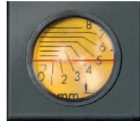
El paso de viruta se puede regular continuamente hasta 8 mm. La lupa le garantiza una lectura exacta de la escala.
