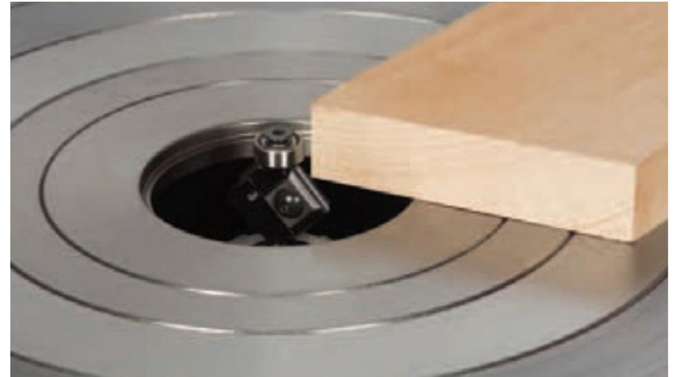
El eje de tupí de alta velocidad acepta todas las fresas de mango con un diámetro de 6 a 16 mm. Velocidad: 16.000 r.p.m., para una potencia del motor máx. de 10,0 CV.
