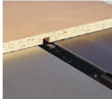
Las escuadradoras Format-4 le permite también realizar trabajos de ranurado. Gracias a la brida desmontable de la sierra circular y a la superficie desmontable de la mesa, puede usted montar las portacuchillas ajustables para ranurar, especialmente concebidas por Format-4.
