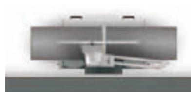
La regla para ensamblar se puede inclinar de 90° a 45°. En la posición de 90° y 45° se encuentran unos topes finales. La construcción de la regla para ensamblar se encarga de que su cepilladora-regruesadora se pueda colocar directamente a la pared y usted pueda utilizar todo el ancho de cepillo.
