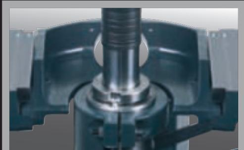
La unidad de eje de fresado con doble fijación de precisión es guiada a través de las guías corredizas de fundición gris. De este modo, ésta "conducción forzada" apoya una vez más la precisión y exactitud en el ajuste.
