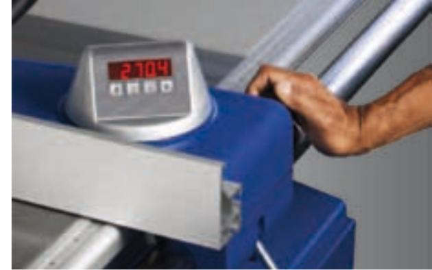
Regla paralela con lector digital y compensación automática de longitud con disco inclinado.
