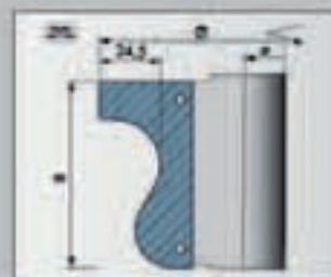
Portachuchillas para perfiles pasamanos, cuchillas intercambiables de metal duro
