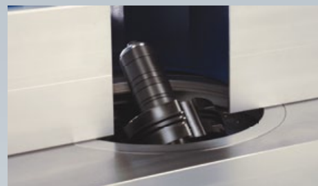
Inclinación de la unidad eje de tupí
