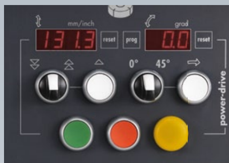
Ajuste de altura e inclinación completamente eléctrico con "Power-Drive"
