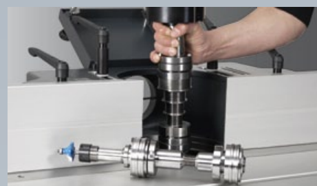
Sistema de cambio rápido del eje
