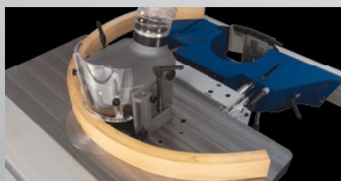
Estándar: Dispositivo basculante del tope de fresado
