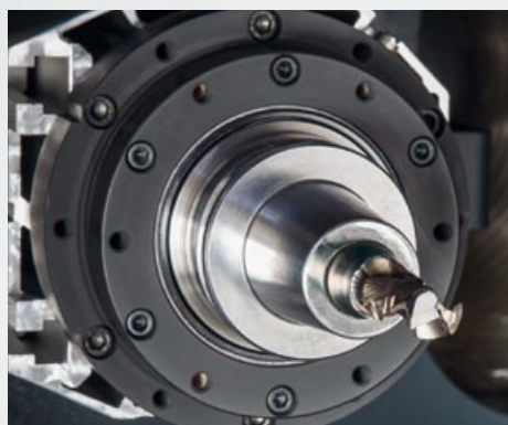
Eje principal de gran rendimiento con conos HSK-F63
