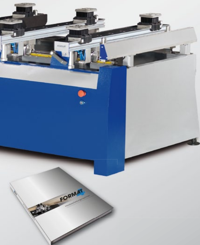
Conexiones en las consolas para mordazas controladas por aire comprimido
