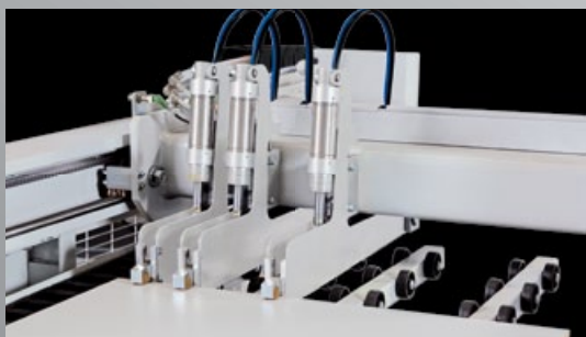
Mordazas con control neumático que aseguran la cogida perfecta del material
