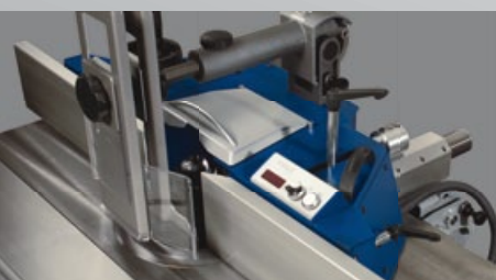
ajuste eléctrico paralelo del tope de fresado sobre botón giratorio
