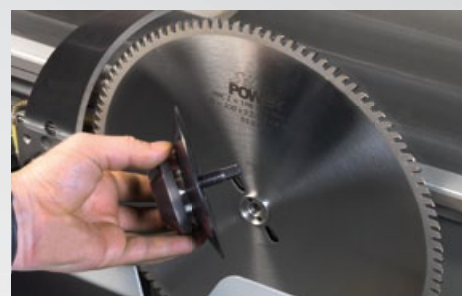
Cambio de disco de sierra sin herramientas
