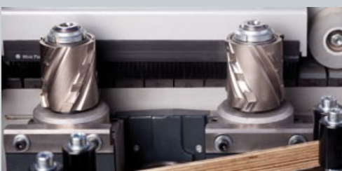
Grupo pre-fresador con fresas de diamante en espiral
