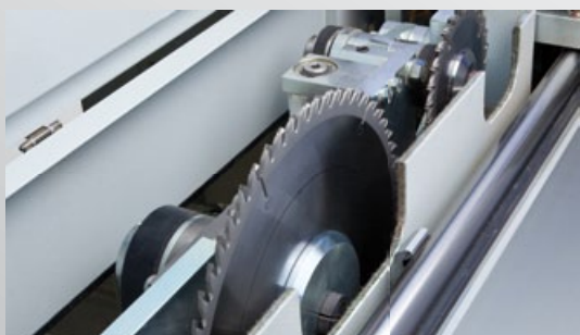
Carro de sierra con agregado principal e incisor
