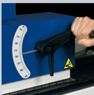
Ajuste de la altura de la barra de presión superior.
