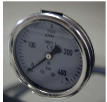
• Manómetro de acero inoxidable y de materiales de alta calidad integrado en la placa trasera de la máquina. Escala de presión en bares (bar).
