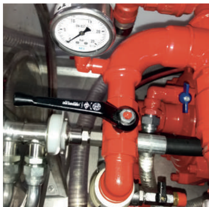
• Salida por rácor Barcelona 25 con espumógeno y manómetro de acero inoxidable y materiales de alta calidad. Escala de presión en bares (bar).
