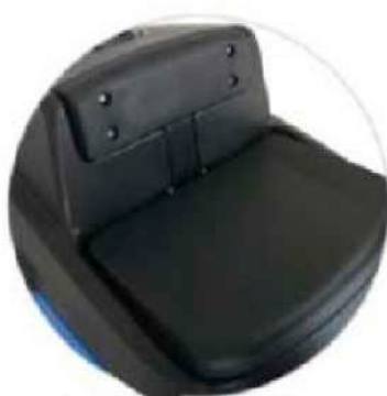
Sistema de detección de presión en el asiento para evitar tocar falsamente el pedal de manejo, lo que podría crear un accidente.
