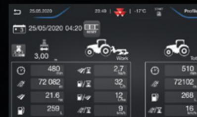
**Memorización de los datos y los ajustes**: el número ilimitado de configuraciones de ajustes de usuarios permite registrar durante el funcionamiento información sobre la superficie trabajada, el consumo de combustible, el número de horas trabajadas, etc. Todos los ajustes y parámetros pueden almacenarse mediante el terminal Datatronic y recuperarse posteriormente en el tractor.
