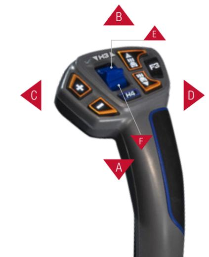
La opción exclusiva de joystick multifunción facilita el control de la pala y proporciona otra opción de inversión, así como la capacidad de ajustar la velocidad del tractor. Los cazos y demás aperos se manejan fácilmente gracias al control proporcional de la tercera válvula, que permite volcar o llenar un apero al mismo tiempo.
