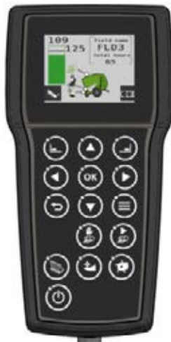
El terminal de control E-Link le permite cambiar fácilmente entre los diferentes ajustes predeterminados de material y niveles de densidad.
