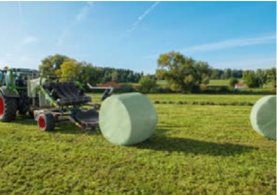
La Rollector 160 está equipada con una mesa para la descarga activa de las balas, evitando eficazmente daños en la película.
