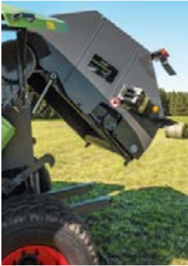
Un pestillo de bloqueo en el portón trasero garantiza que esté cerrado de forma fiable, incluso cuando se está utilizando en pendientes.
