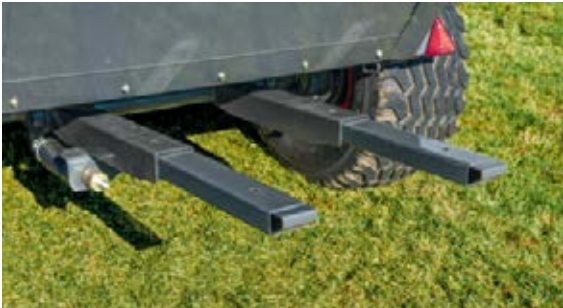
La rampa de balas, que puede ajustarse sin herramientas, ofrece a la bala el momento deseado y evita una colisión entre el portón trasero y la rampa de balas.
