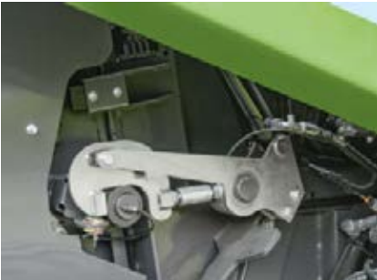
El pestillo de bloqueo mecánico es el garante de balas de alta resistencia y de un cierre fiable del portón trasero.
