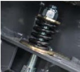
El muelle Flexcontrol absorbe los picos de carga desde la parte delantera del suelo del bastidor de corte, lo que impide que se produzcan bloqueos.
