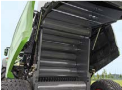
Un total de 18 rodillos PowerGrip activan la rotación y garantizan una compactación homogénea.
